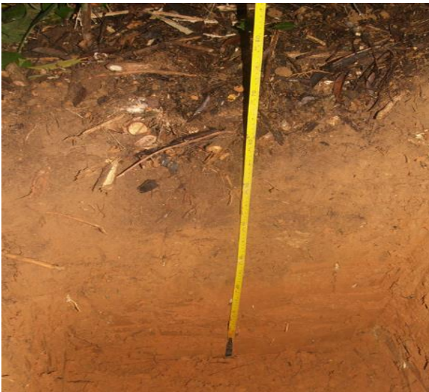
Foto 6. Apertura de calicata
