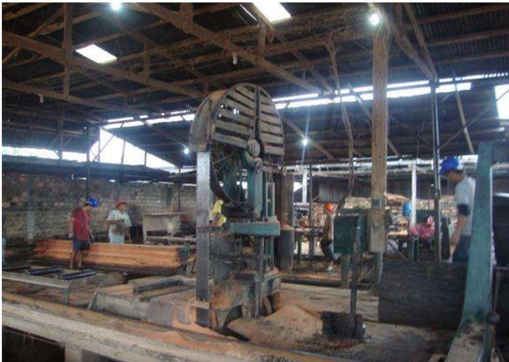
**Figura 6.** Sierra principal de cinta de la planta de aserrío de FORESTAL ARPA S.A.C.
