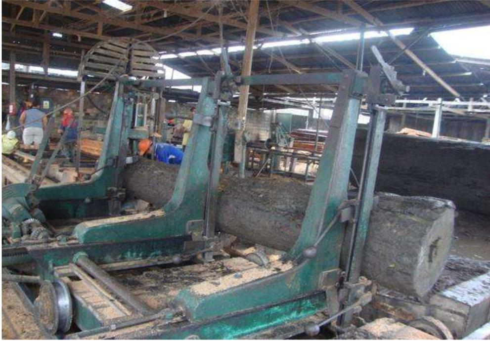
**Figura 7.** Troza de cumala (*Virola sp.*), en proceso de aserrío en la planta de aserrío de FORESTAL ARPA S.A.C.
