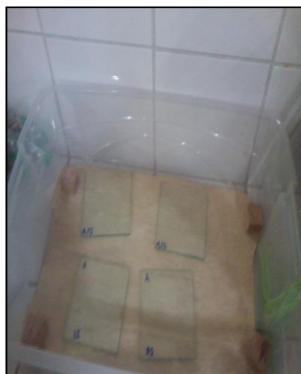
Imagen N° 12. Colocación de las placas ya pesados en el multiusos para su traslado a la estación de muestreo. CIRNA – UNAP.
