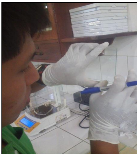
Imagen N° 09. Rotulación de las Placas 10x10cm 2 , para su correspondiente pesado en la balanza analítica. CIRNA – UNAP.
