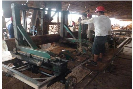
**Figura 3.** Carro porta trozas del aserradero Netrimac SAC
