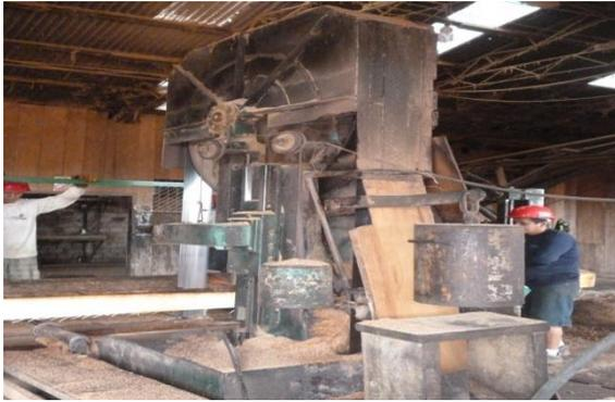
**Figura 2.** Sierra Principal del aserradero Netrimac SAC
