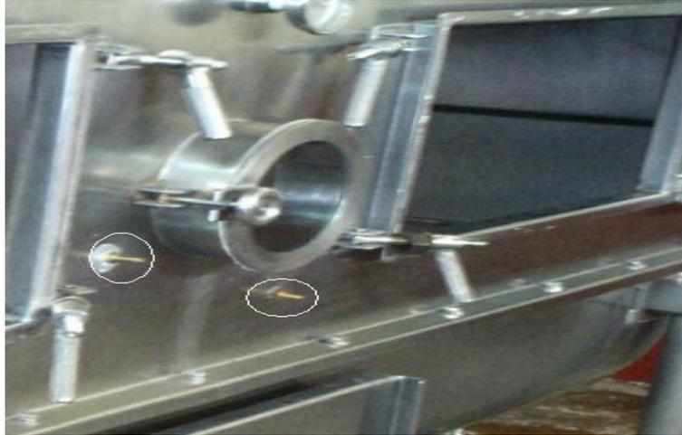
Figura N° 12: Boquillas para conectar el manómetro tipo “U” instalado en el equipo.
