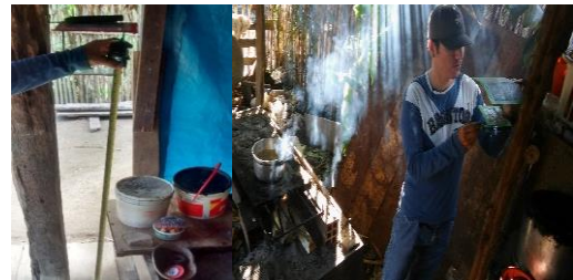
Foto N° 09. Instalación de Estaciones a 1.50m de distancia del punto de emisión de humo, bajo un área donde no caen gotas de lluvia, a una altura de 1.60m respecto al suelo (talla promedio de las mujeres que usan las cocinas), como también para que este fuera del alcance de los niños y en un área donde no haya transitabilidad de personas.
