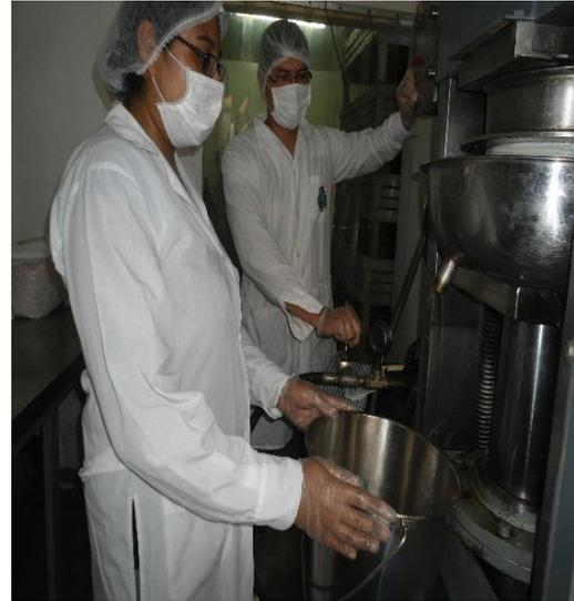
Proceso de extracción de AcPlukenetia por prensa hidráulica
