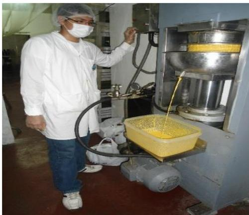
Proceso de extracción de AcMauritia por prensa hidráulica
