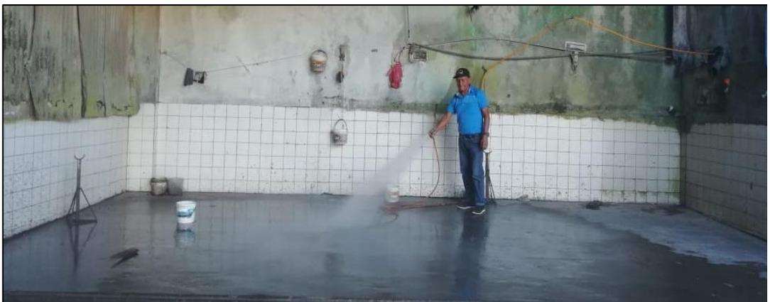
Aforo con el método volumétrico dentro del reservorio.
