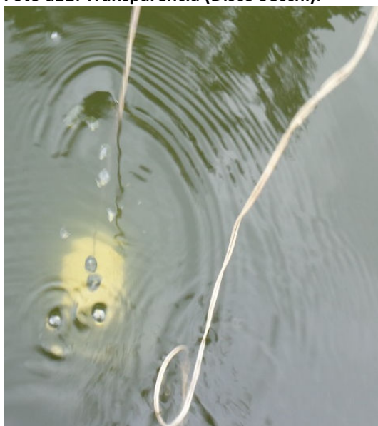
Foto a11: Transparencia (Disco Secchi).
