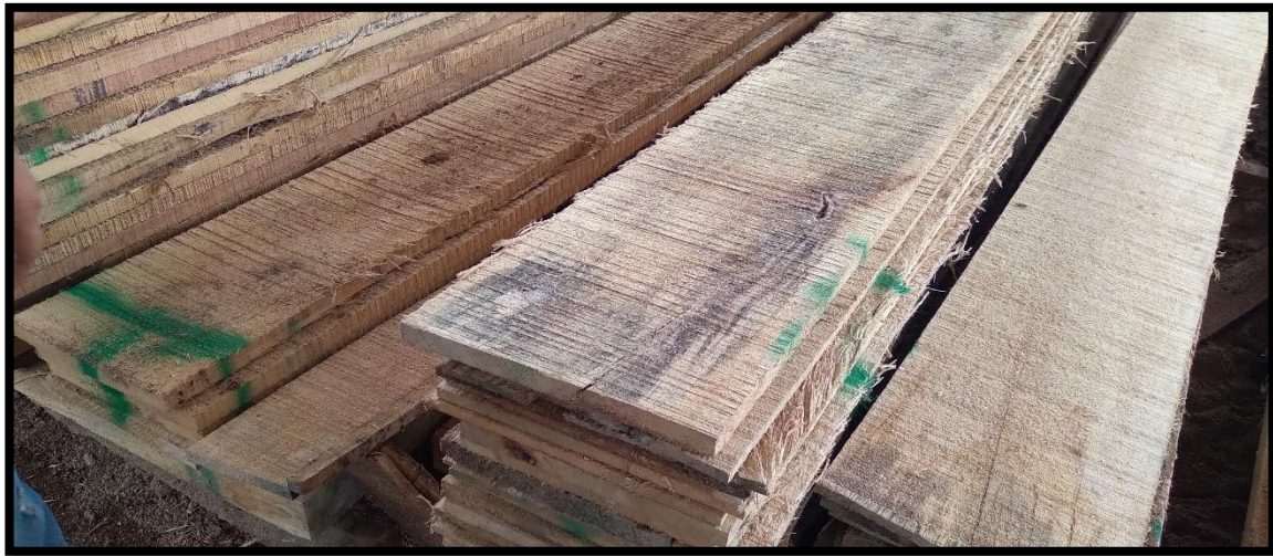
Figura 3: Tablas con distintos defectos: descalibradas y mal preservadas
