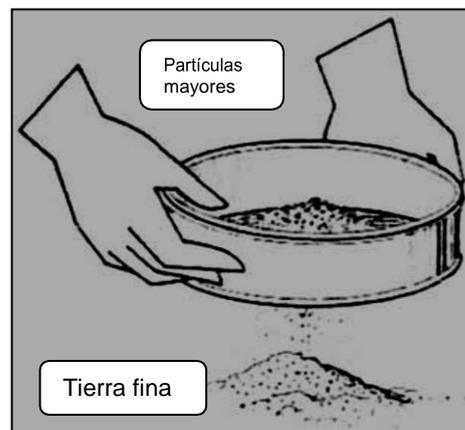
Para realizar los ensayos de campo siguientes asegúrese de utilizar sólo tierra fina. Si la bola se desmorona, el suelo es pobre y contiene demasiada arena; si la bola mantiene su cohesión, probablemente sea un suelo bueno con suficiente arcilla.
