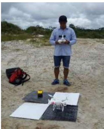
Figura 17. Fotografía realizando la calibración del Drone
