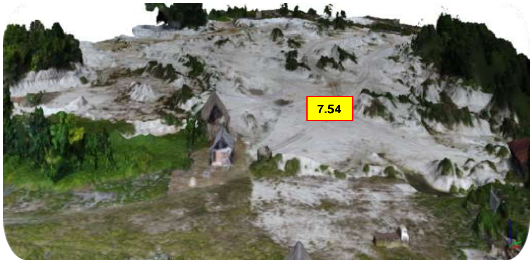
Figura 39. Perfil del Terreno en 3D para la medición de la Altura Potencial de Aprovechamiento de la Cantera “Chelita III”
