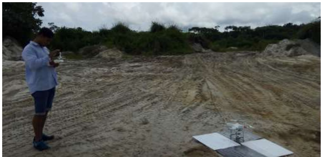
Figura 20. Fotografía donde se alista el despegue del Vehículo aéreo no tripulado "Drone" con el plan de vuelo insertado.
