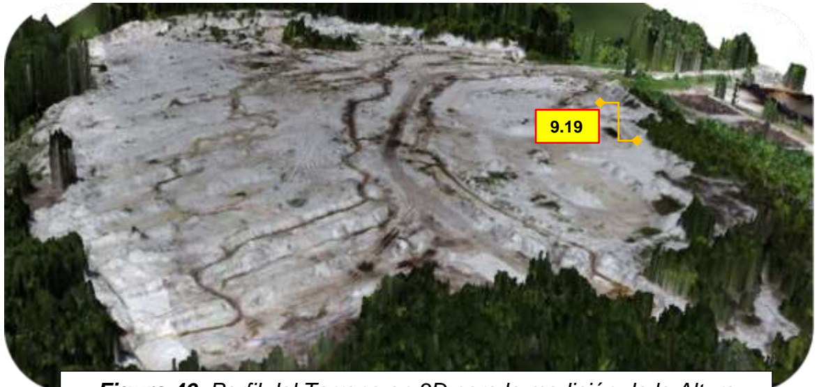
Figura 46. Perfil del Terreno en 3D para la medición de la Altura Potencial de Aprovechamiento de la Cantera “Las Galeras”
