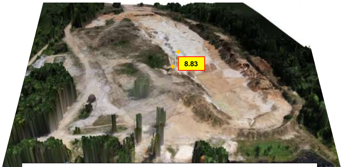
Figura 47. Perfil del Terreno en 3D para la medición de la Altura Potencial de Aprovechamiento de la Cantera “El Brashico”
