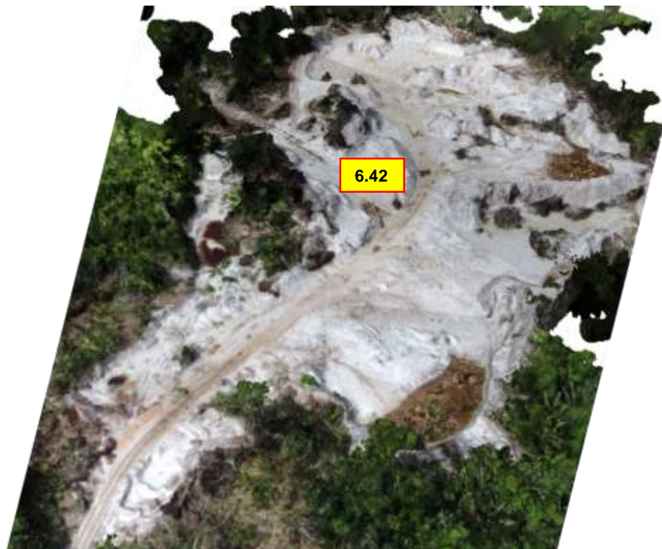
Figura 40. Perfil del Terreno en 3D para la medición de la Altura Potencial de Aprovechamiento de la Cantera “Las Amazonas (A)”
