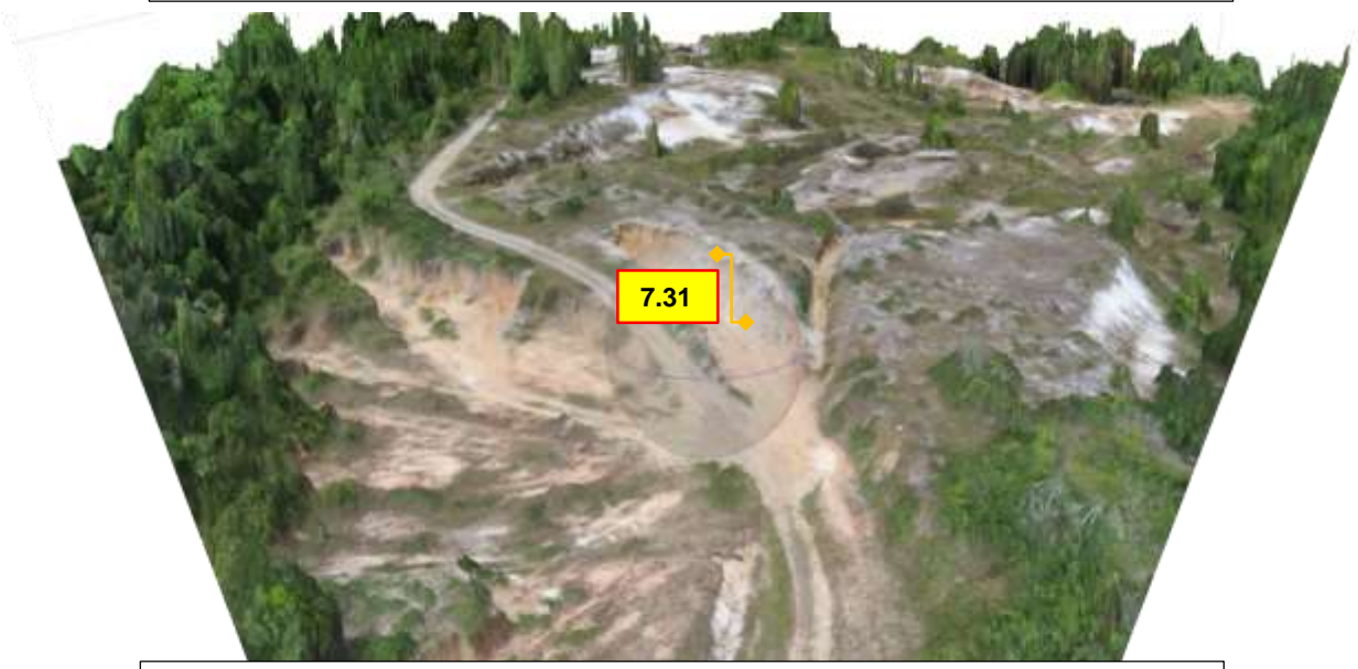
Figura 43. Perfil del Terreno en 3D para la medición de la Altura Potencial de Aprovechamiento de la Cantera “Betty Pinedo Panaifo”
