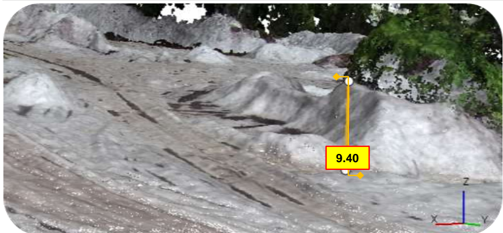
Figura 45. Perfil del Terreno en 3D para la medición de la Altura Potencial de Aprovechamiento de la Cantera “Villa Milagrito (A) y (B)”
