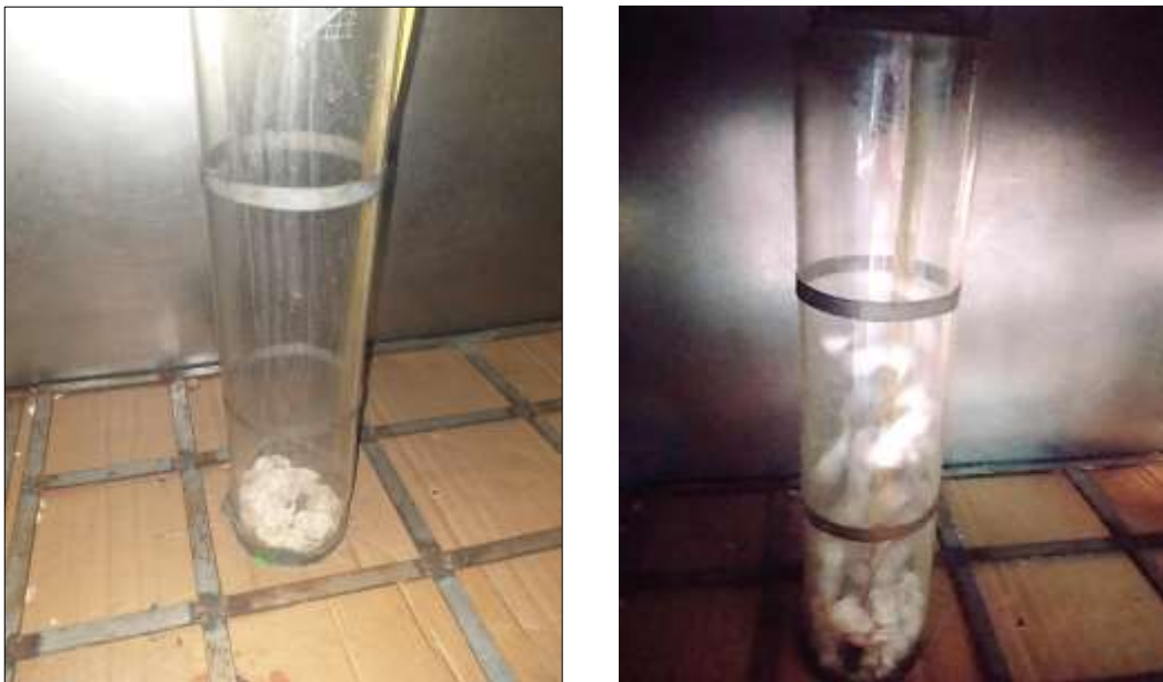
Figura 17. Secado en el horno de lecho fluidizado de la materia prima seca.
