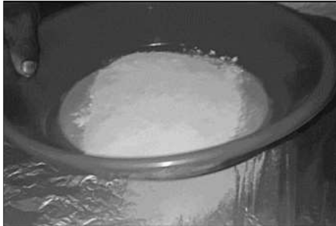
Figura 19. Tamizado de la materia prima seca.
