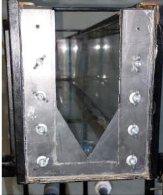
**Figura 13.** Vertedero triangular de  $60^\circ$  instalado en el canal abierto.
