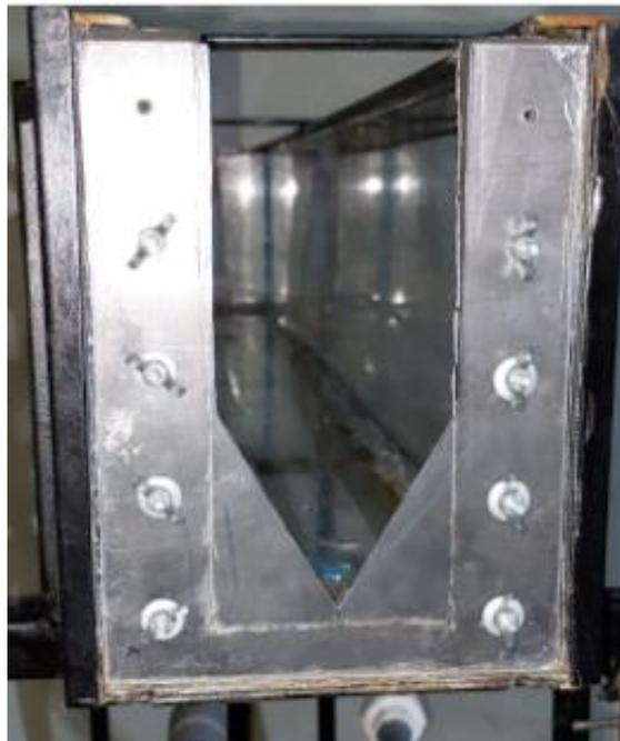
**Figura 18.** Vertedero triangular de 60° instalado en el canal abierto.
