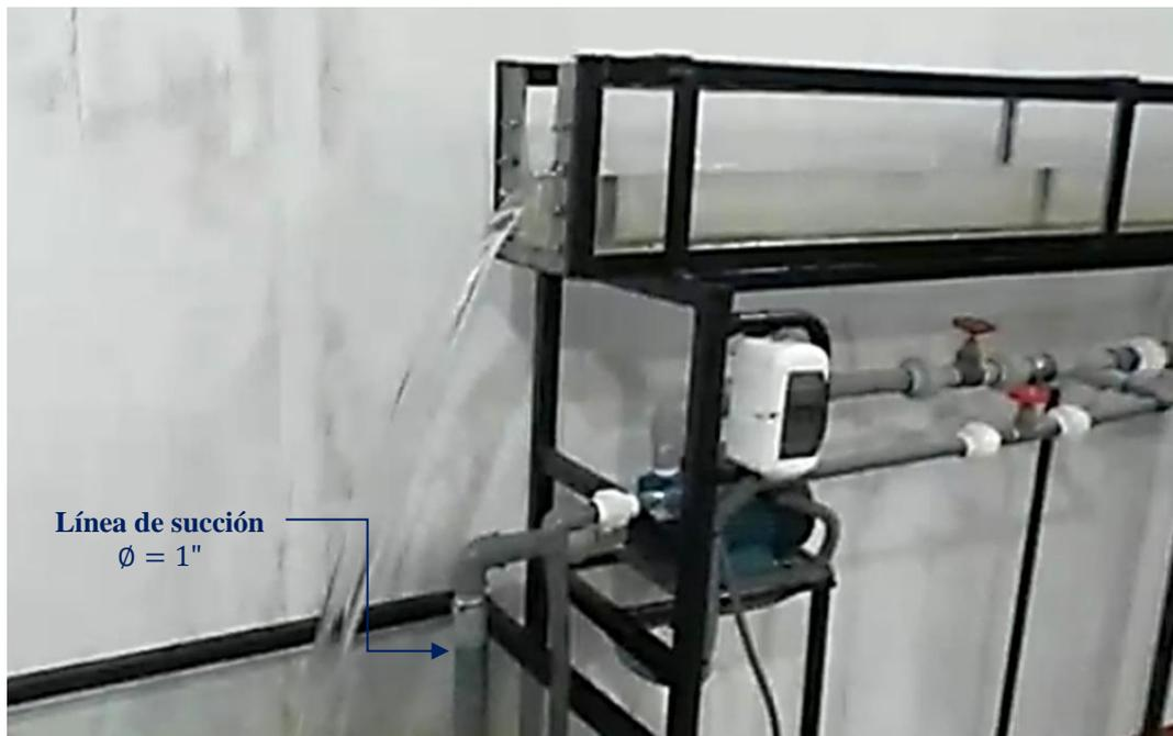
**Figura 17.** Prueba de funcionamiento del equipo modular.
