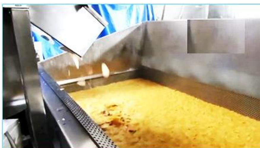
**Figura 38: Fritura de hojuelas en batch de cocción, freidora FRV-I**
