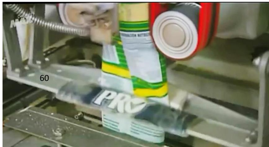
**Figura 59 y 60: Sellado de bolsas de Chifles de Plátano Verde en máquina automatizada**
