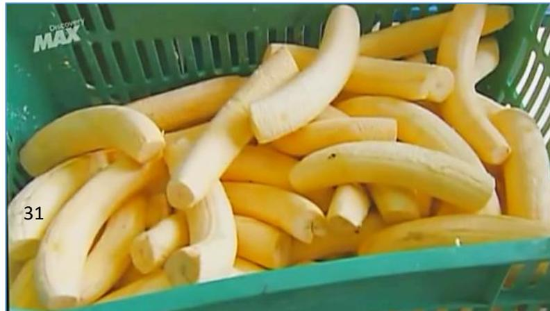
**Figuras 27, 28, 29, 30 y 31: Operación de pelado del plátano verde**
