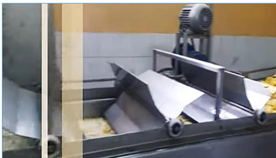
**Figura 37: Fritado de las hojuelas de plátano en máquina freidora con sistema continuo de cocción.**
