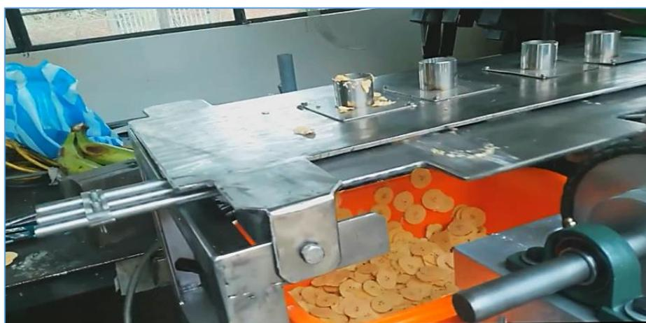
**Figura 36: Corte de hojuelas de plátano en máquina semiautomatizada**
