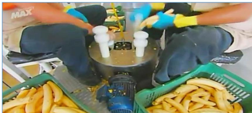
**Figura 34: Operarios realizando el corte de hojuela de plátanos en cortador semi automática**
