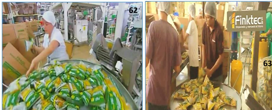
**Figuras 62 y 63: Empacado de producto terminado desde plataforma giratoria de recepción para almacenaje y comercialización**
