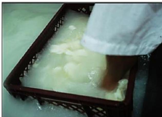
**Figura 73: Proceso de desalmidonado por método de inmersión en agua**
