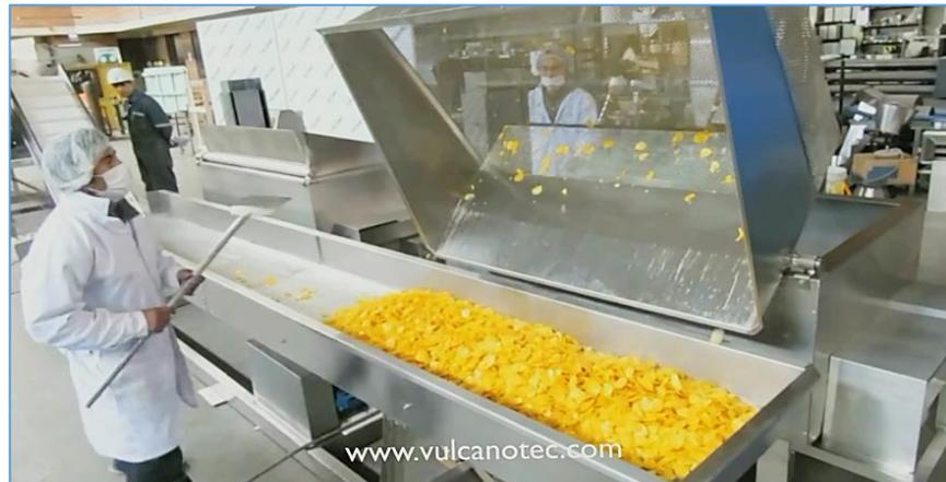
**Figura 43: Enfriado de las hojuelas fritas de plátano en mesa vibratoria MVV-I.**
