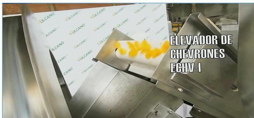
**Figura 44: Chifles de plátano transportados en el elevador de chevrones<sup>19</sup> ECHV-I hacia el dosificador y tambor sazonador.**
