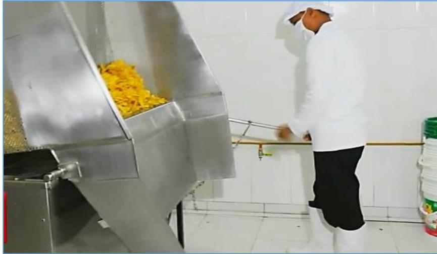
**Figura 42: Enfriado y escurrido de hojuelas fritas de Plátano en malla de sumersión de palanca.**
