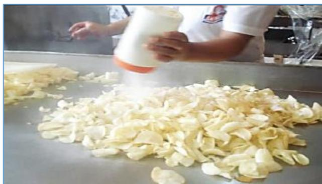
**Figura 78: Saborización de las hojuelas por método manual**
