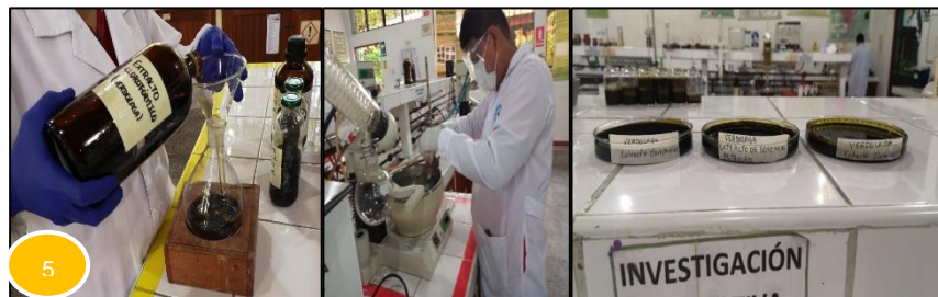
Concentración y Secado de los filtrados
