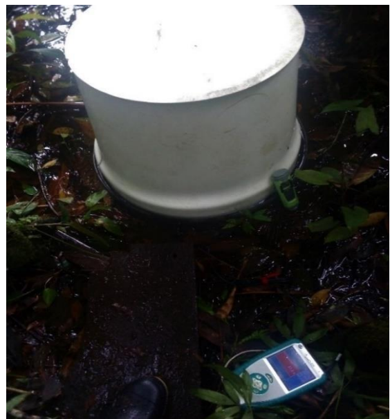
Figura 21. Muestreo de los gases en un vial de 50 ml, en horas de la noche.
