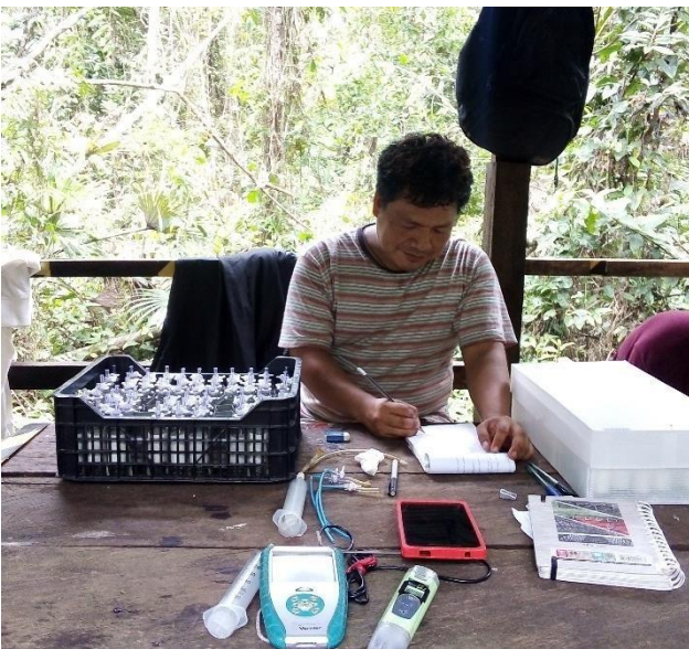
Figura 18. Codificación de los frascos para el muestreo de los gases de CH_4 y N_2O .
