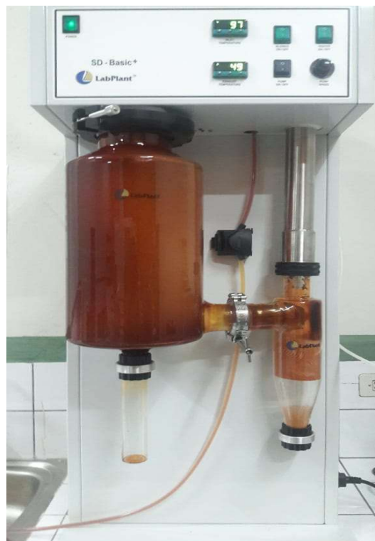
Equipo atomizador con residuos de proceso de atomización.
