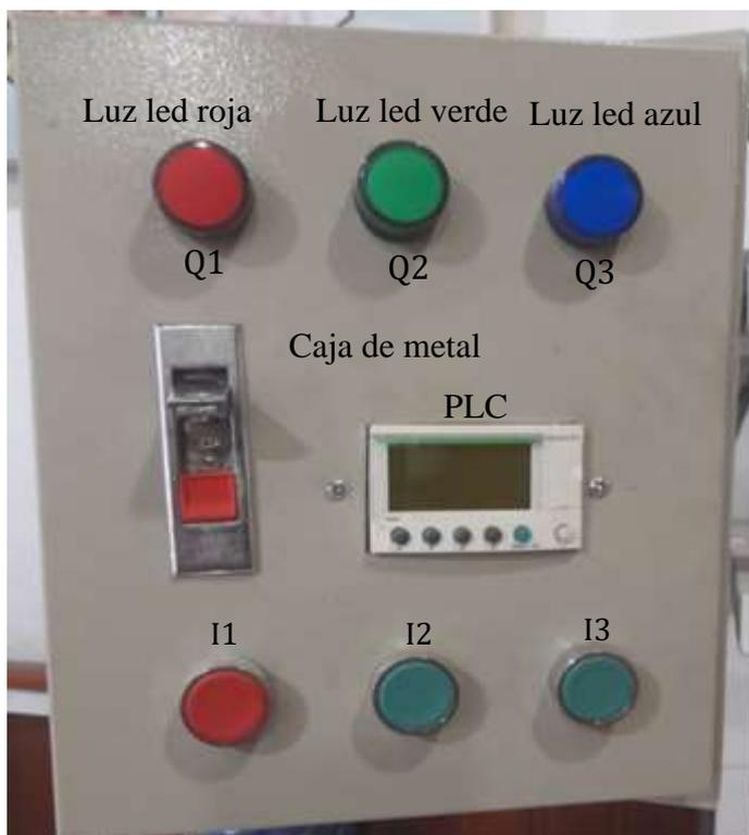
Q1: está conectada en forma paralela a la luz led roja y a la válvula solenoide izquierda.
