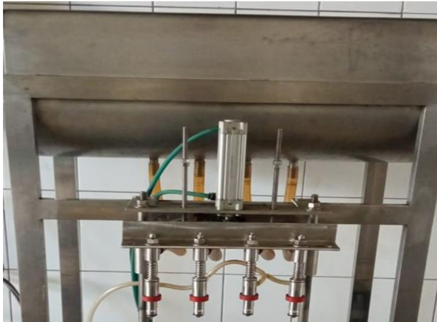
Figura 12: Mangueras de alimentación conectadas a las válvulas llenadoras.
