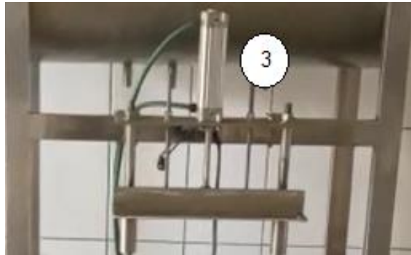
Figura 14: Actuador neumático de llenado
