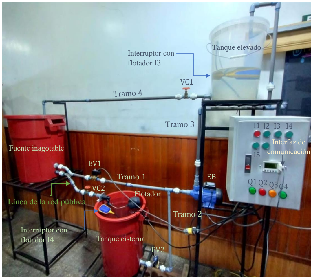
Figura A1. Imagen real del equipo para el estudio del control automático del nivel de líquido en dos tanques.
