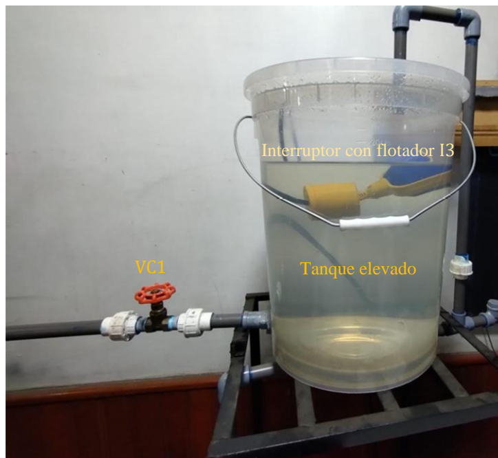
Figura 25. Imagen real del tanque elevado y del interruptor con flotador I3.
