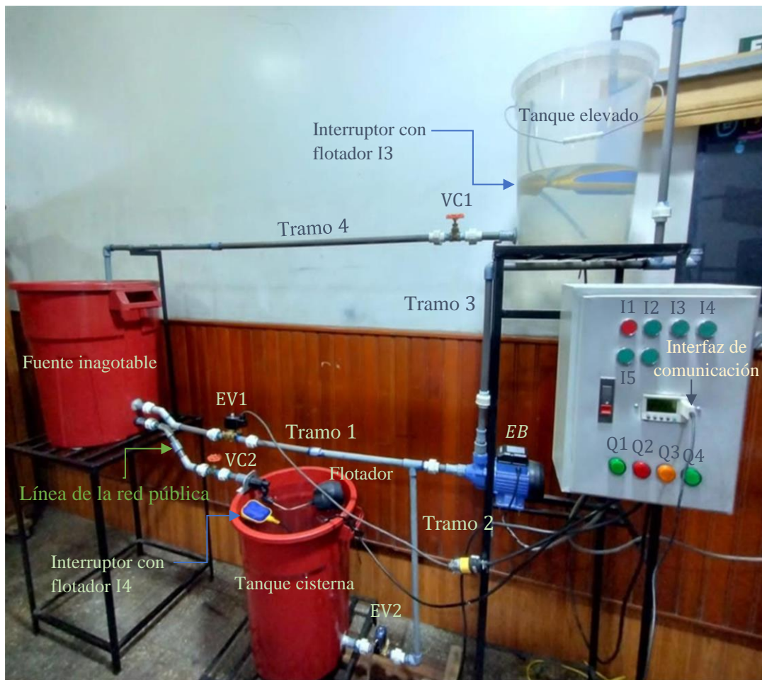
Figura 22. Imagen real del equipo para el estudio del control automático del nivel de líquido en dos tanques.
