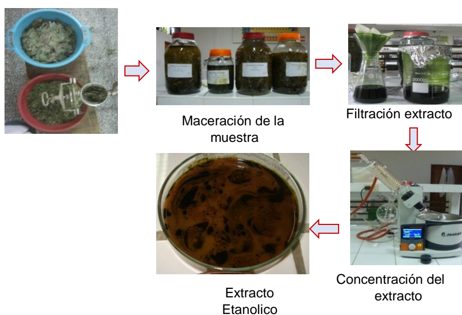
Figura N° 28. Obtención de los extractos etanolicos de la raíz de T. heterophylla Vahl.
