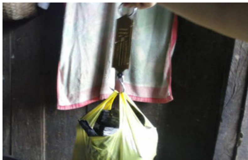
Foto 3. Uso de la balanza Romana para el pesado del carbón
