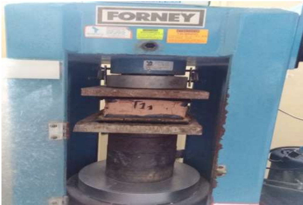
Foto 13. Adobe sufriendo rotura por la fuerza de la compresora
