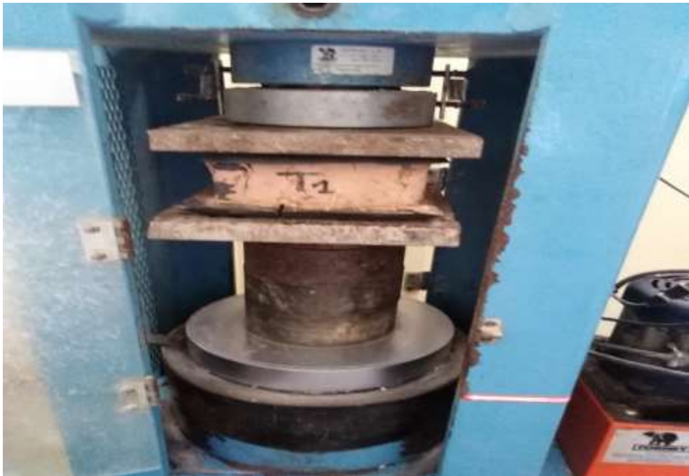
Foto 12. Muestra de adobe para su prueba de compresión
