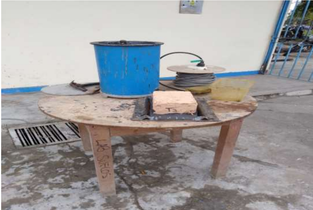
Foto 9. Preparación del adobe para su prueba de compresión
