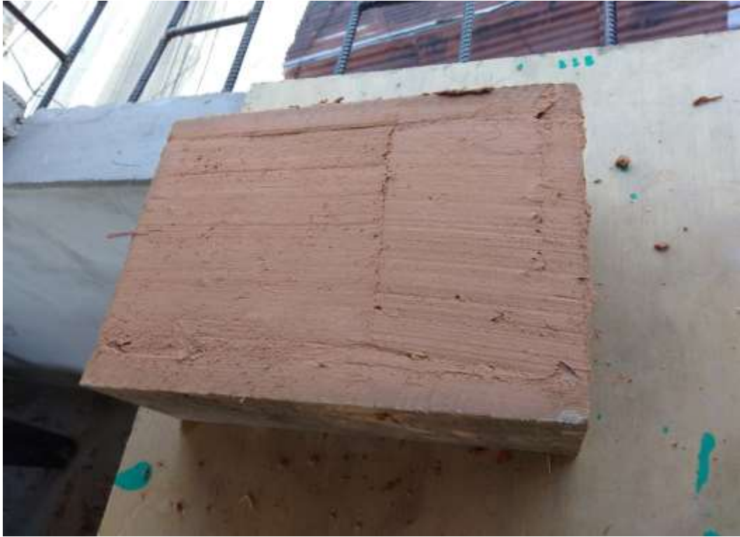
Foto 7. Llenado de la tierra en los moldes
