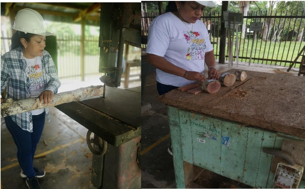
Elaboración de muestras de xilotecas de orientación radial, tangencial, cubos y probetas. (carpintería)
