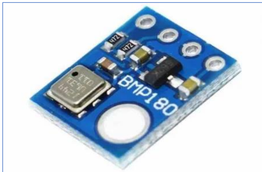
Figura N° 11: Sensor de presión para arduino.
