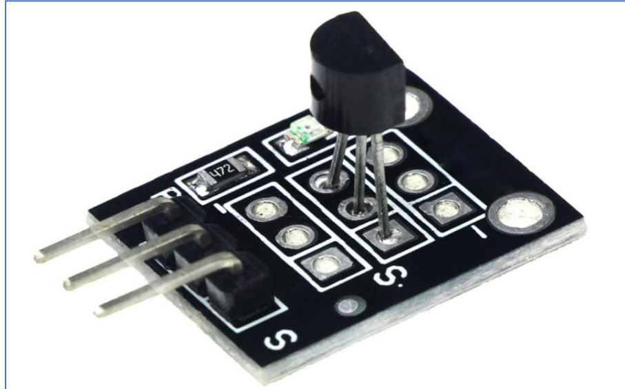
Figura N° 10: Sensor de temperatura para arduino.
