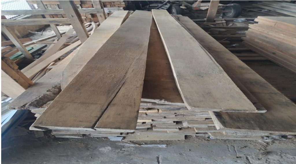
Figura 07: Calidad de madera con presencia de rajaduras, hongos y descalibrado
