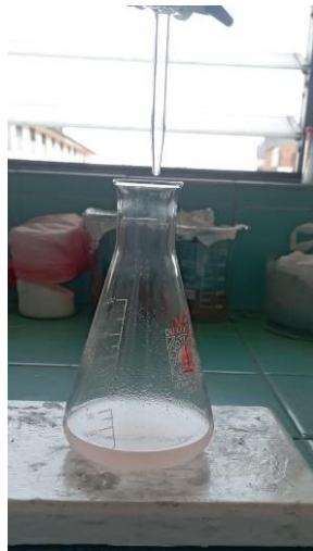
Figura 20. Titulación culminada para el cálculo del porcentaje de ácidos grasos libres
