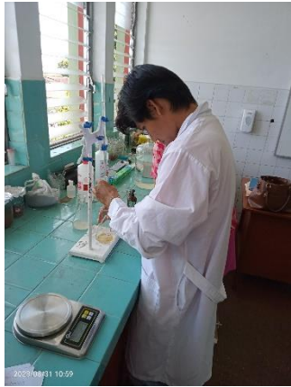
Figura 21. Titulación para el índice de peróxidos
