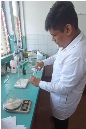
Figura 18. Titulación para el índice de acidez
