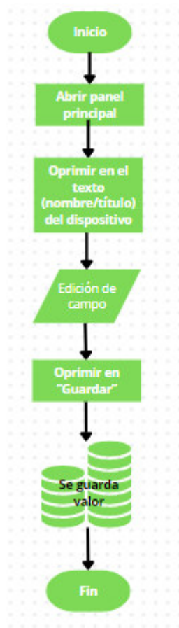
FIGURA 15. Diagrama de flujo para editar nombre del dispositivo a gestionar.
