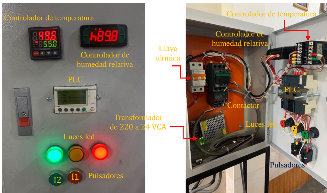
Figura A2. Componentes principales del prototipo para el control automático de temperatura y humedad relativa en secadores con calentamiento eléctrico.
