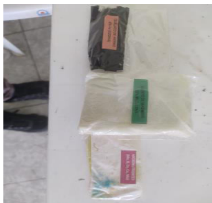
Solución B: Micronutrientes, Sulfato de magnesio y quelato de hierro en 2 litros de agua.
