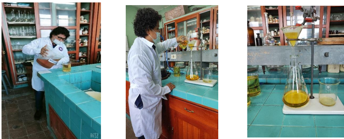
Decantación, filtración y almacenamiento del AVU
