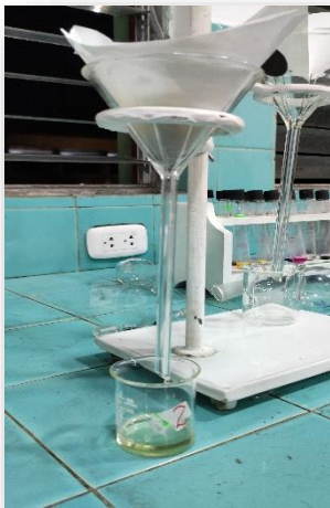
Figura 2.11 Proceso de purificación del biodiésel
