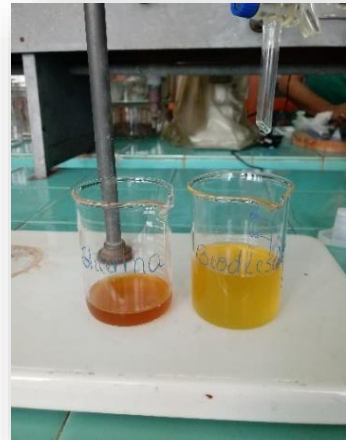
Separación de las fases Glicerina/ Biodiésel
