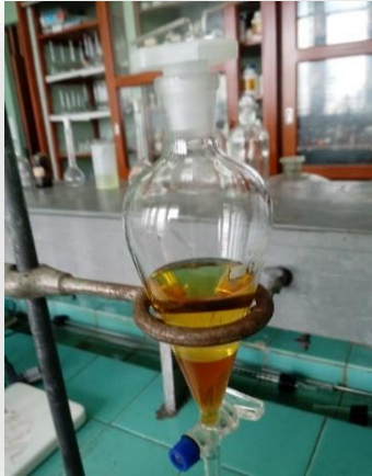
Separación de las fases Glicerina/ Biodiésel
