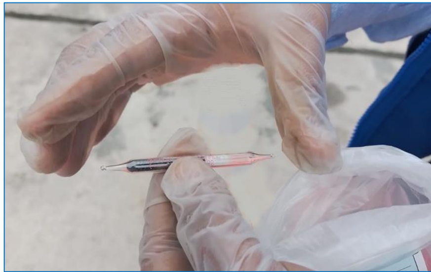
Figura N° 1: Tubo de carbón activado
