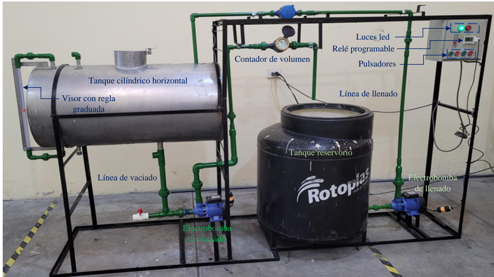
Figura 18. Equipo para el llenado y vaciado de un líquido en un tanque cilíndrico horizontal, después de la implementación del sistema automatizado.
