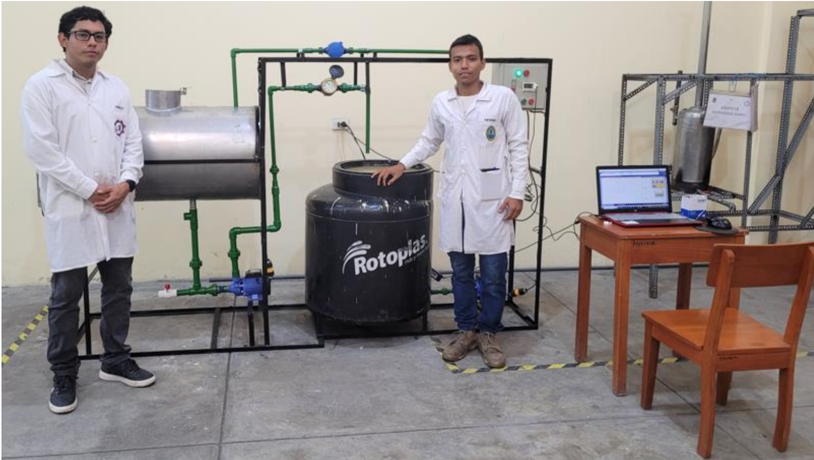
Anexo 4. Vistas de las pruebas de funcionamiento del sistema automatizado para el llenado y vaciado de un líquido en un tanque cilíndrico horizontal.
