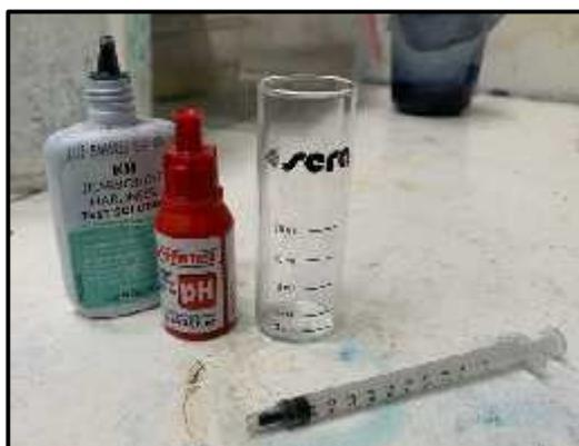
**Figura N° 8:** Equipos básicos para medición de parámetros físicos y químicos del agua en la crianza de peces ornamentales utilizados por acopiadores y acuaristas de Iquitos.
