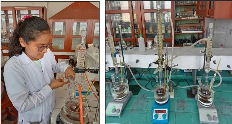
Realización de la hidrólisis ácida a pH (1.5, 2.5, 3.5), temperatura (60, 75 y 80 °C) y tiempo (45, 60, 75 min).
