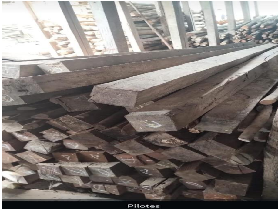
Figura 12. Pilotes de Quinilla, utilizadas en la construcción civil
