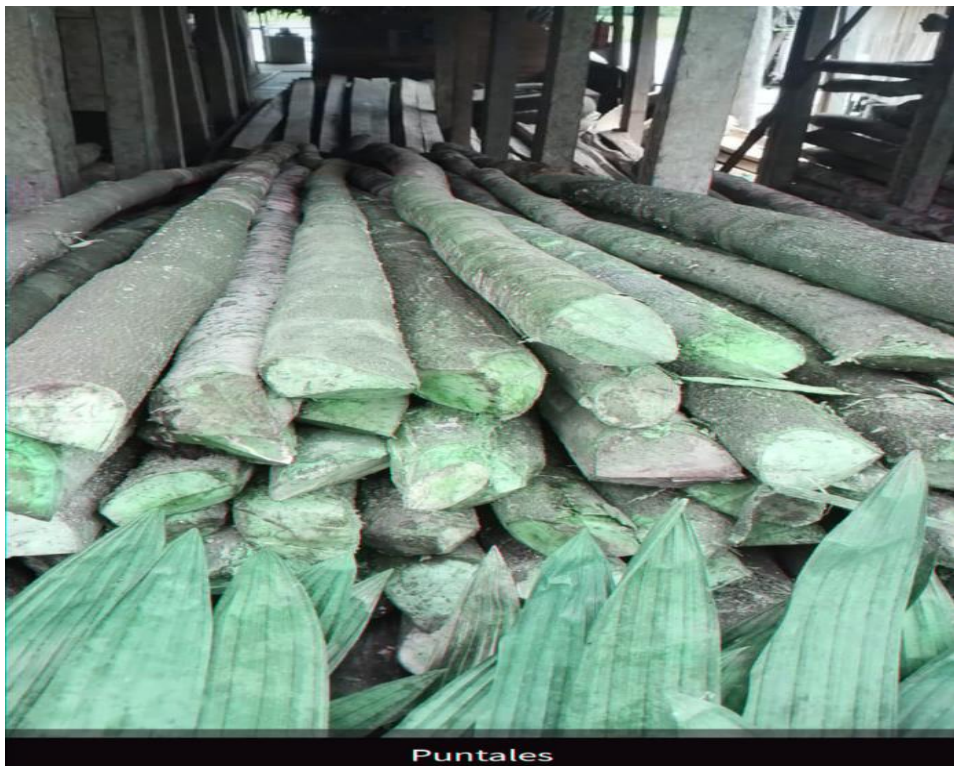
Figura 15. Puntales de espintana, utilizados en la construcción civil
