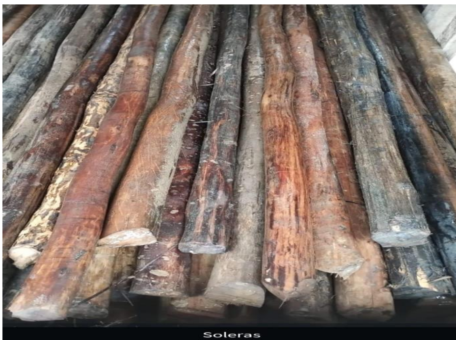
Figura 12. Pilotes de Quinilla, utilizadas en la construcción civil
