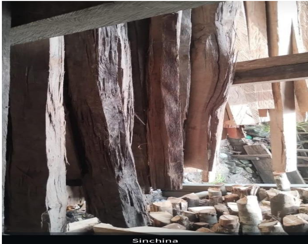
Figura 16. Sinchinas de remo caspi, utilizados en la construcción civil
