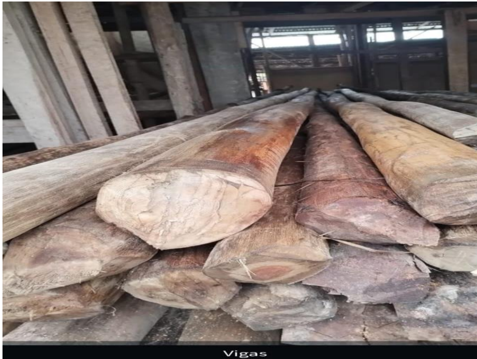
Figura 14. Vigas de carahuasca, moena, utilizados en la construcción civil
