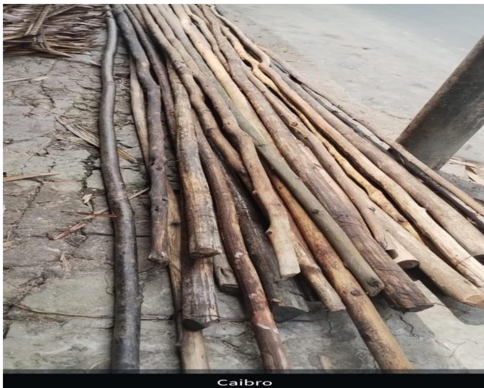
Figura 17. Caibros de especies diversas, utilizados en la construcción civil
