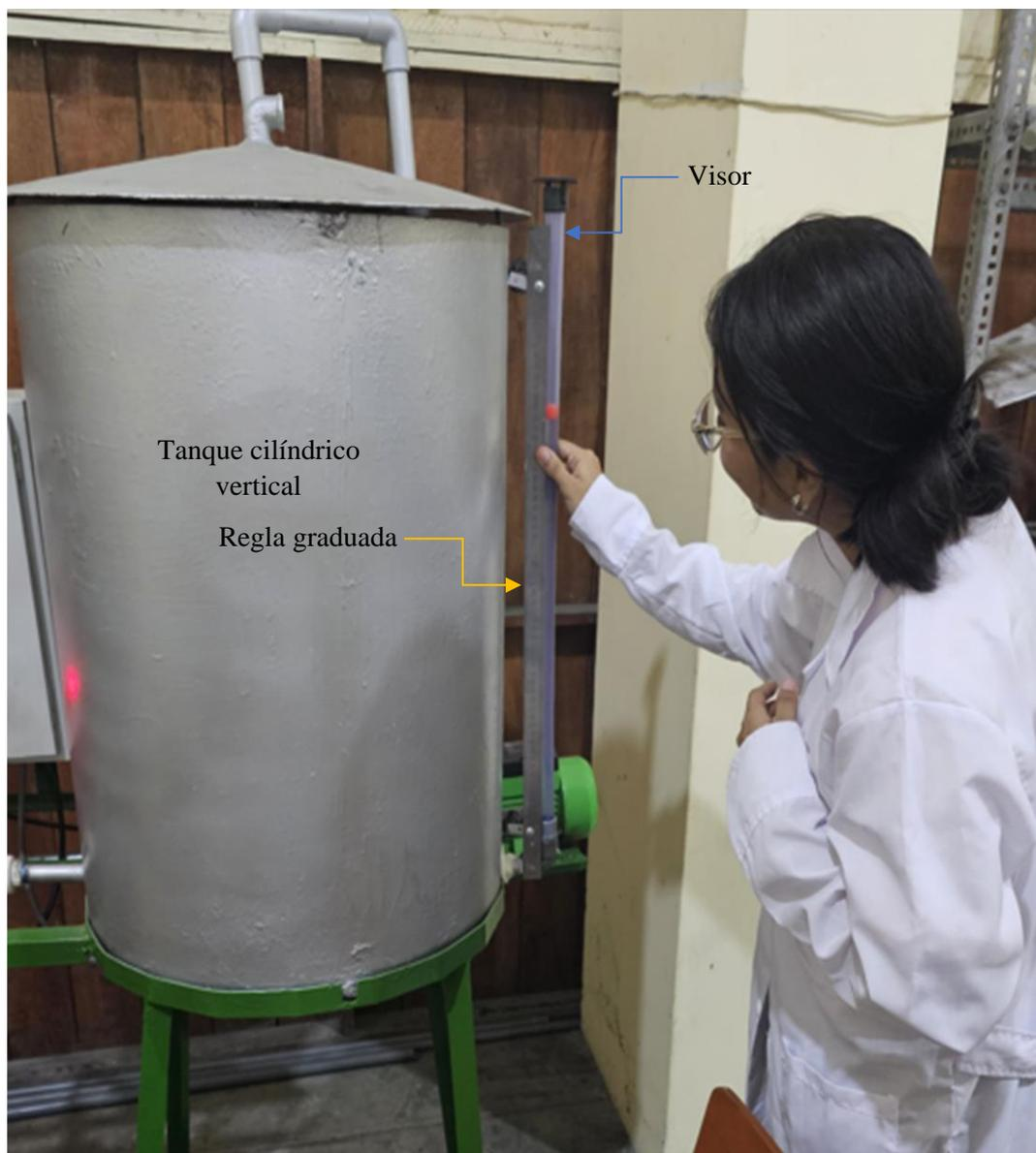
**Figura 17.** Tanque cilíndrico vertical, el visor y la regla graduada.
