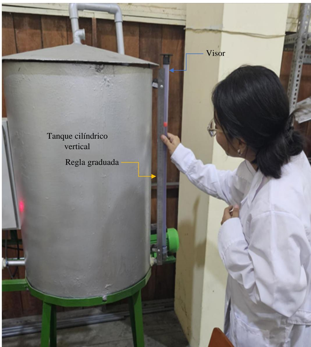
**Figura A2.** Tanque cilíndrico vertical, el visor y la regla graduada.
