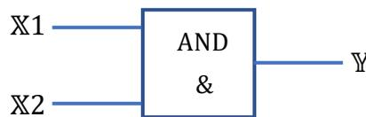
**Figura 3.** Representación de la compuerta AND mediante un BDF.
