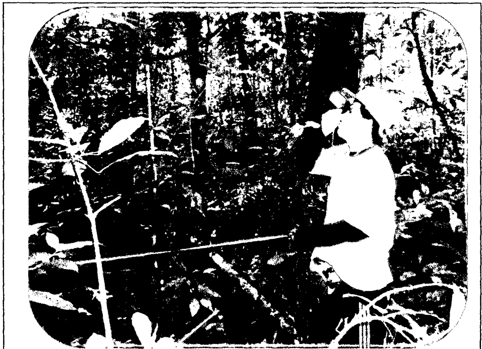
Figura 2: Medición de la altura del árbol con clinómetro Suunto
