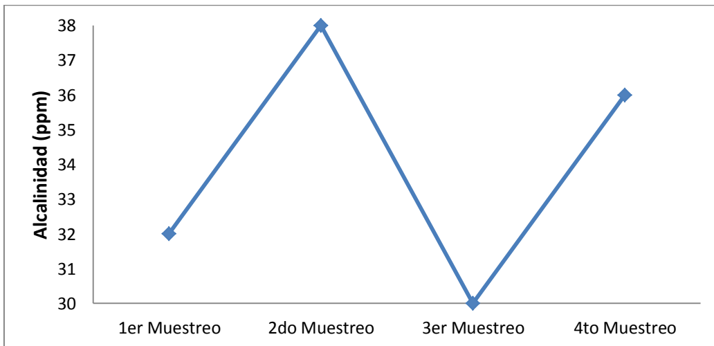
Gráfico N° 7.- Variación mensual de la alcalinidad (ppm) del agua durante la fase experimental.
