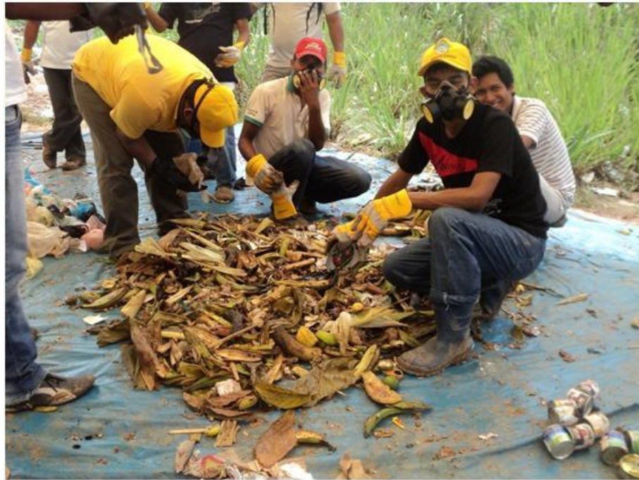
Foto 1. Cuarteo de residuos sólidos
