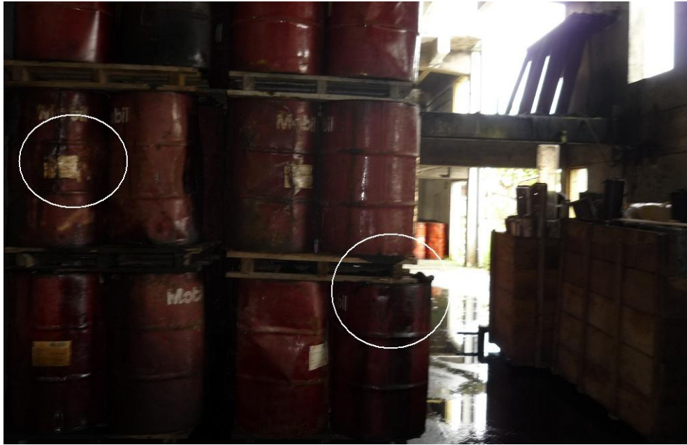
Imagen N° 03. Contenedores de residuos peligrosos con fugas
