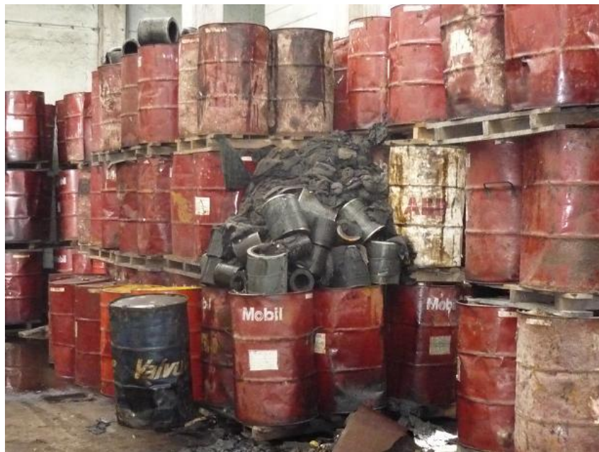
Imagen N° 01. Disposición inadecuada de residuos peligrosos
