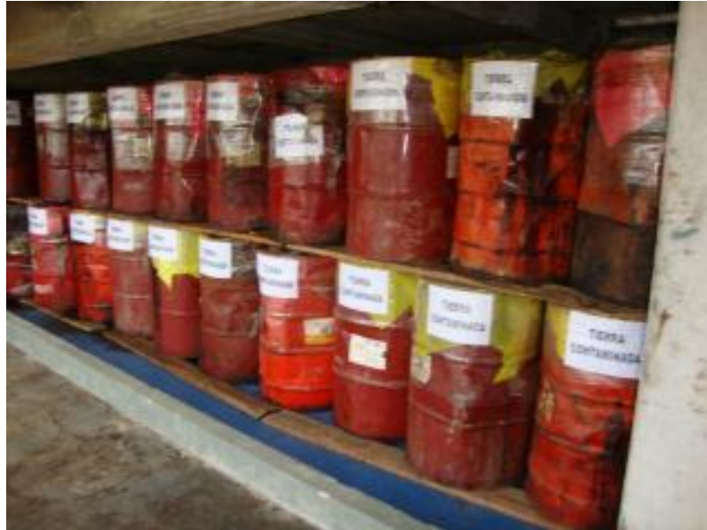
Imagen N° 08. Etiquetado de residuos peligrosos y disposición dentro de área de contención.
