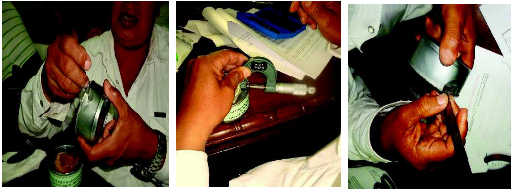
FIGURA N° 71: Control de las Medidas de Cierre de la Conservas Tipo Solido de Paiche.
