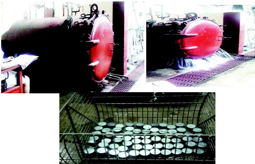
Figura N° 45: Autoclave, donde se realiza el enfriamiento de la latas de conserva
