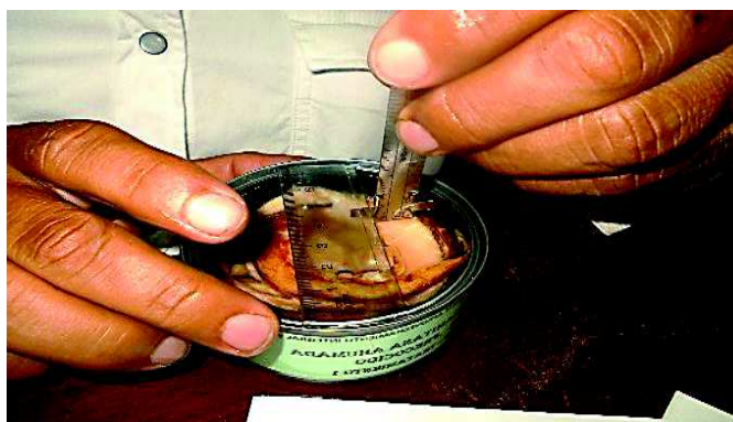
Figura N° 73: Determinación del Espacio Libre de la Conservas de solido de Paiche.
