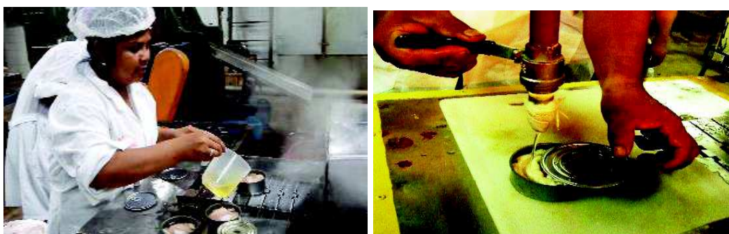
Figura N° 64: Control del llenado del Líquido de Gobierno (Salmuera y Aceite Vegetal.)
