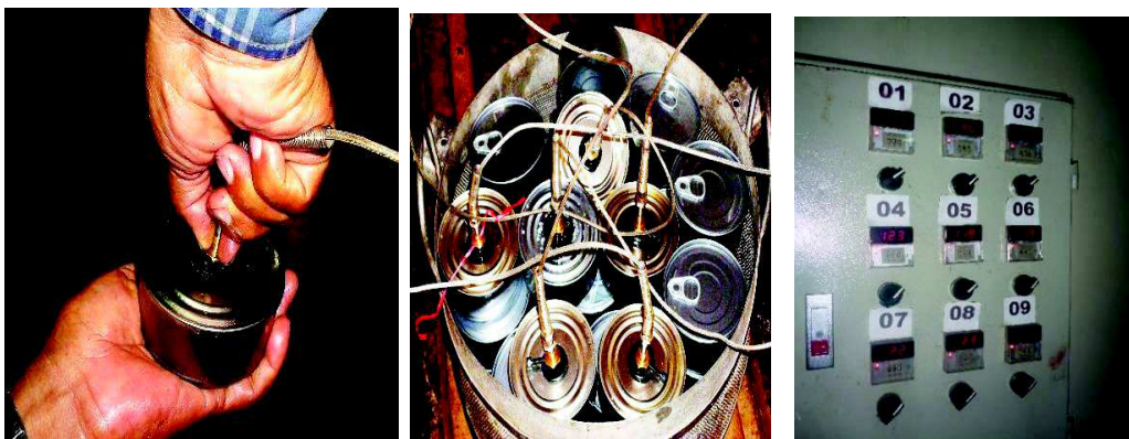
Figura N° 69: Control de la medición de la F_0 en la autoclave en la etapa de Esterilización durante el proceso de Obtención de conserva de solido de Paiche
