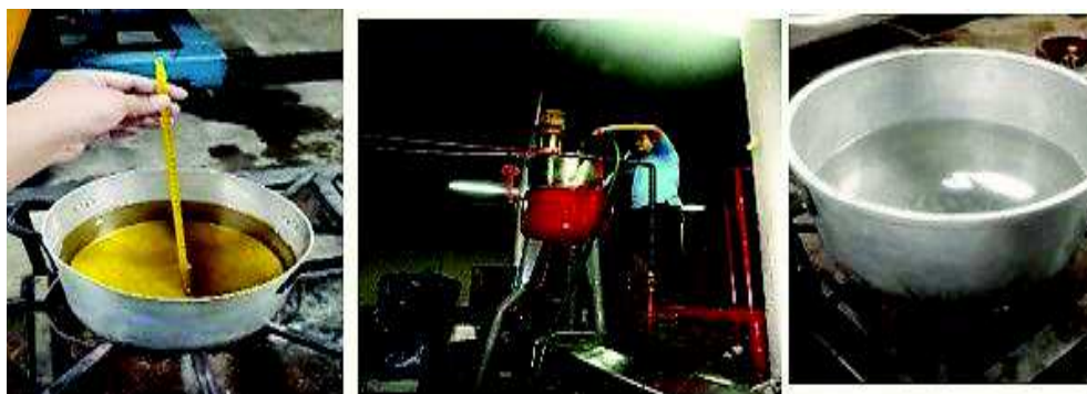
Figura N° 63: Control de La Temperatura del Líquido de Gobierno (Salmuera y Aceite Vegetal.)
