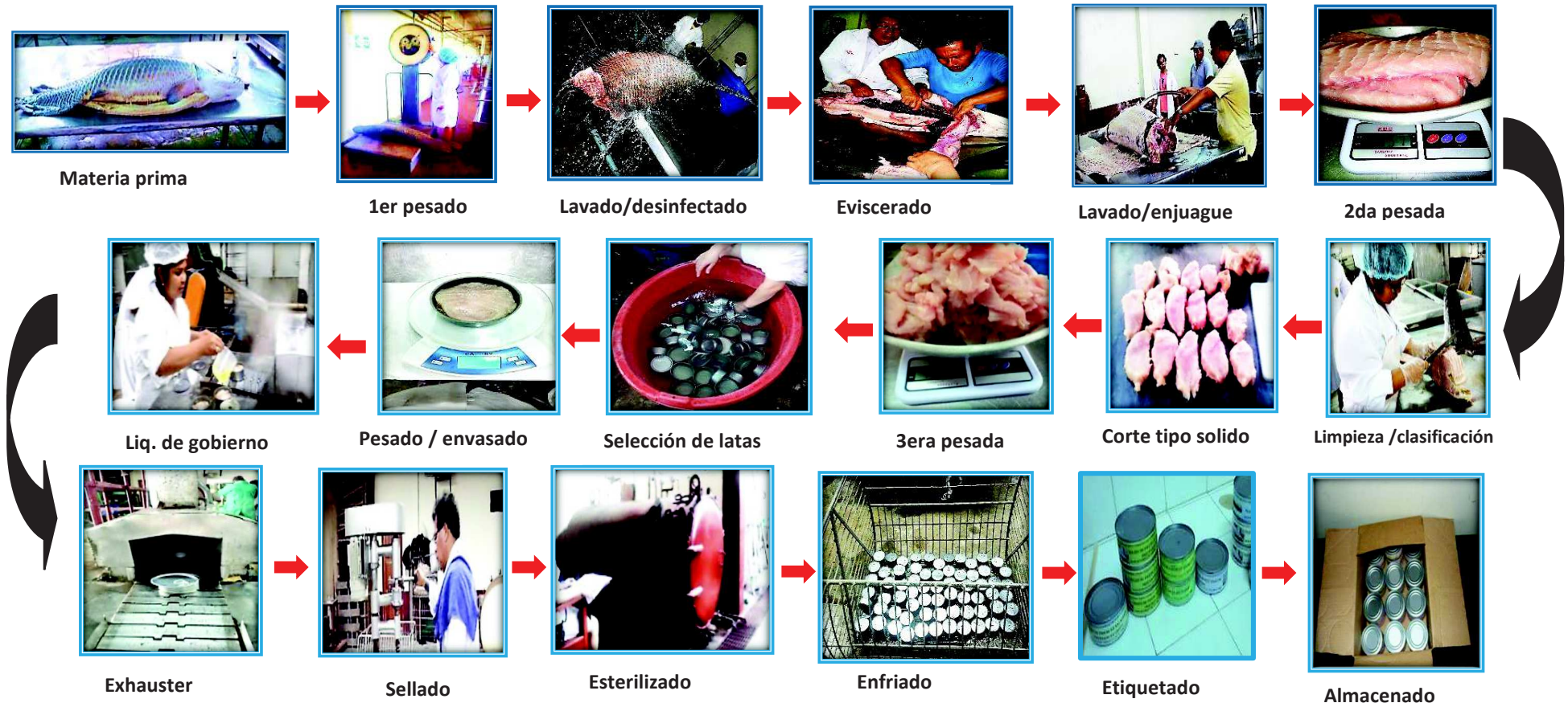
Figura N° 60: Flujo de proceso definitivo para obtener Conserva enlatada Tipo Solido a partir de PAICHE en la línea crudo
