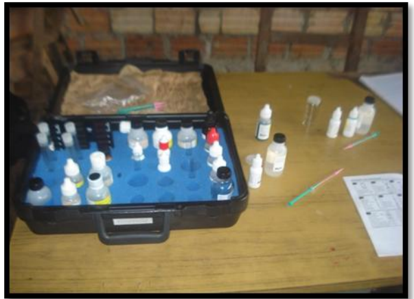
Foto 10: kit marca LAMOTTE modelo AQ-2 – para el análisis limnológico.
