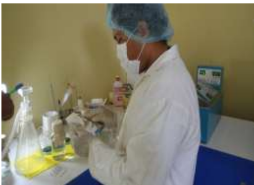
Foto 17 y 18: Proceso de filtrado de la muestra de agua para análisis
