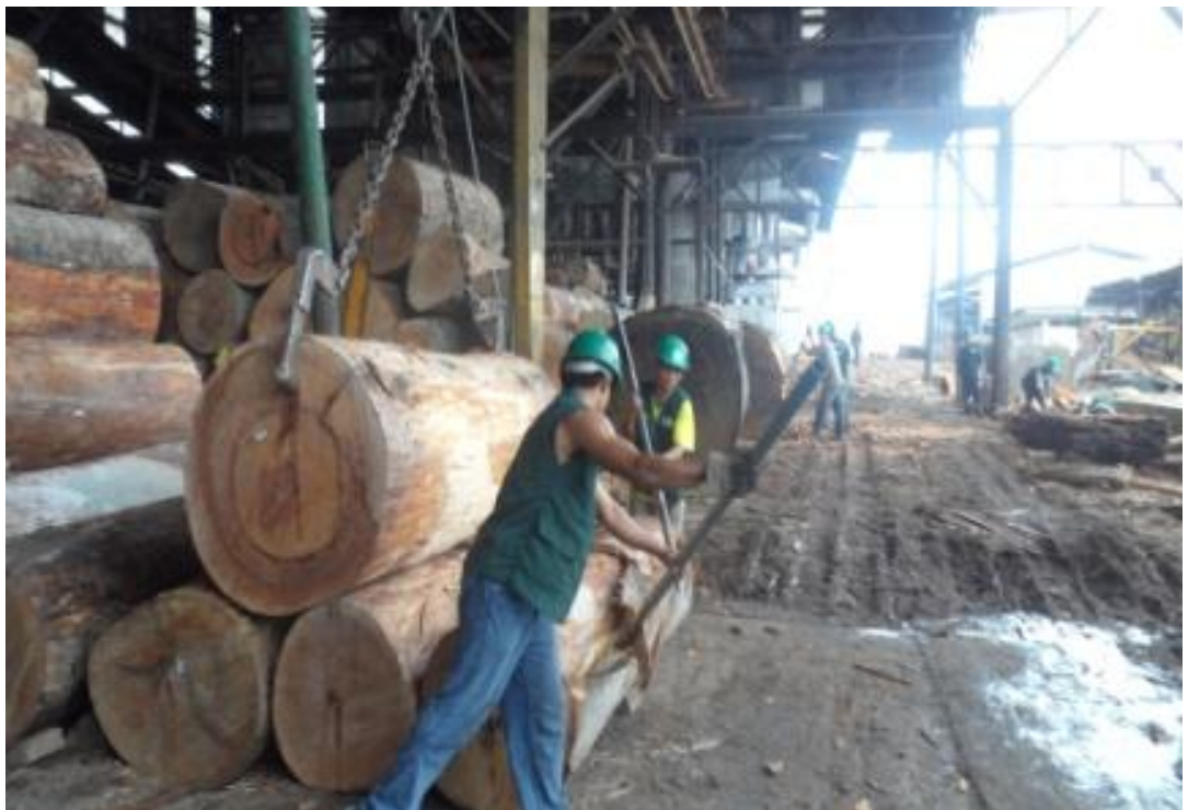
Figura N°04: Descortezado de las trozas antes de su ingreso al torno
