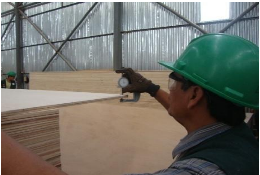
Figura N°33: Verificación del espesor de las planchas.
