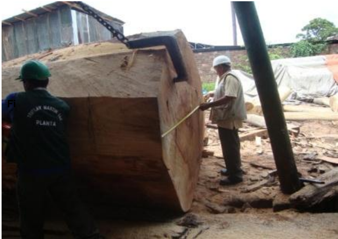
Figura N°05: Medición del diámetro de las trozas antes de su ingreso al torno.
