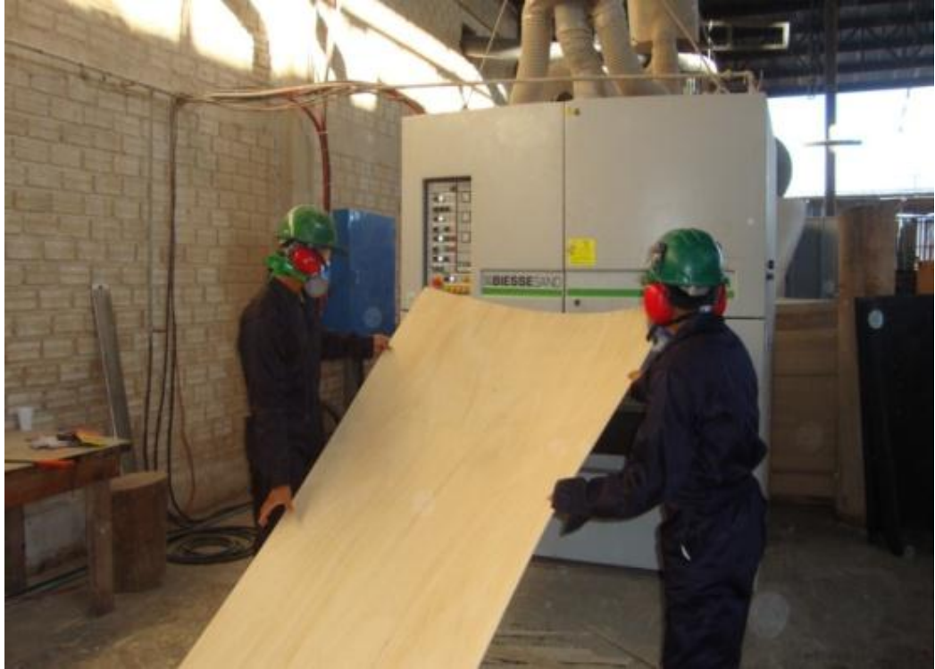
Figura N°29: Lijadora de planchas Biesse-Sand
