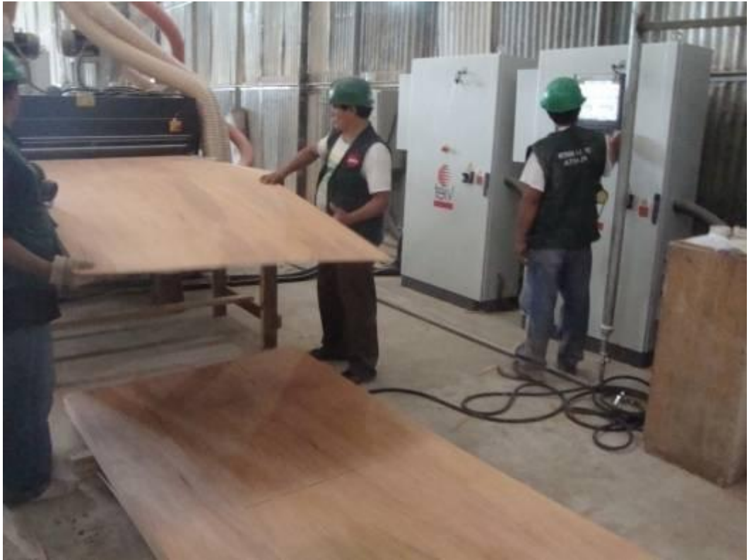
Figura N°31 : Verificación del pulido de las planchas de triplay.
