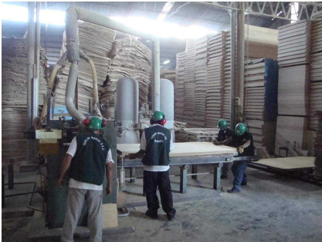
Figura N°27: Corte en la escuadradora manual.
