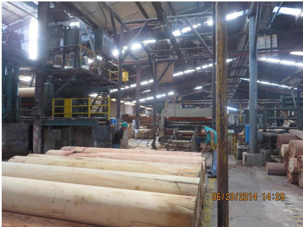
Figura N°10 : Polines para ingreso al torno pequeño de recuperación.
