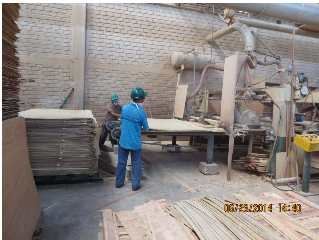
Figura N°28: Corte en la escuadradora semiautomática.
