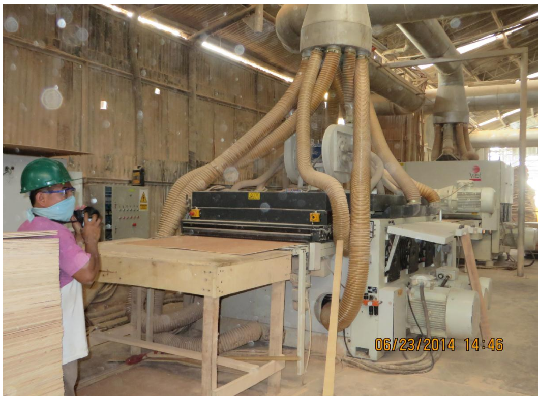
Figura N°29: Lijadora de planchas Biesse-Sand
