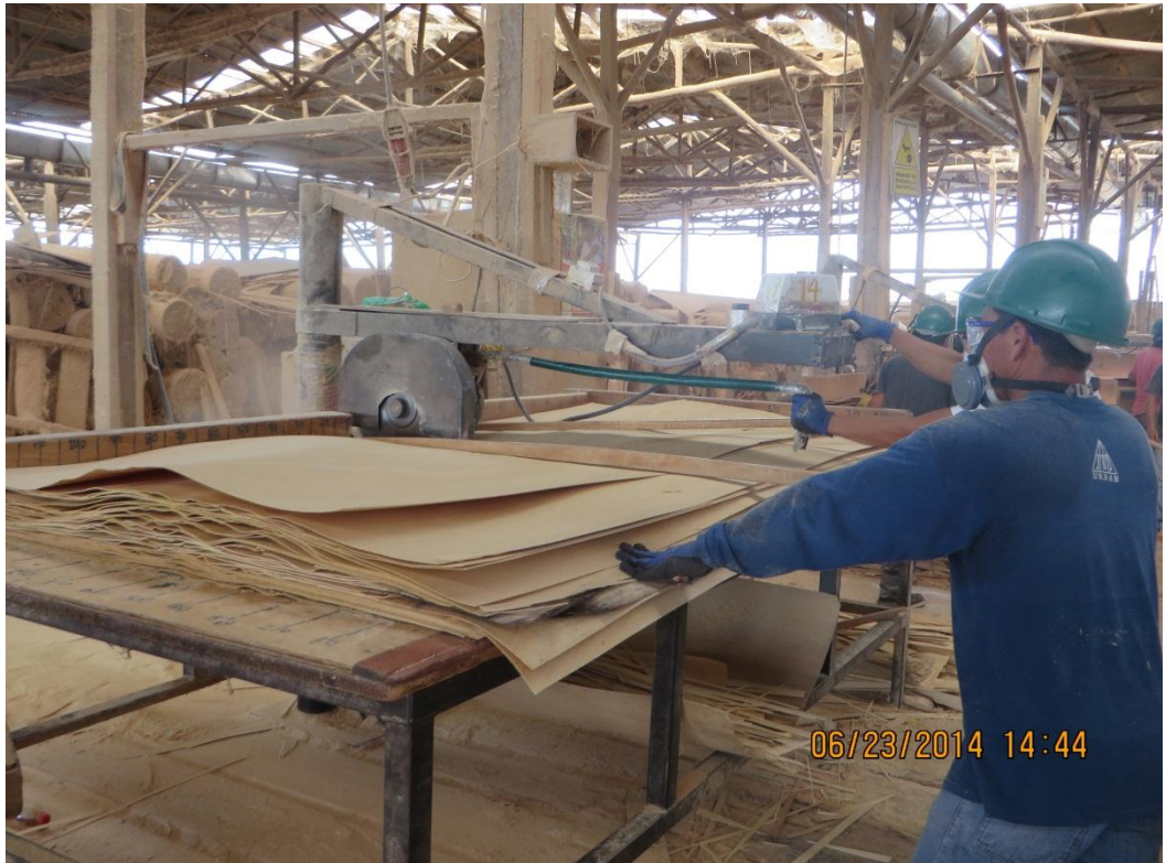
Figura N°16: Corte de láminas secas en las Sierras circulares
