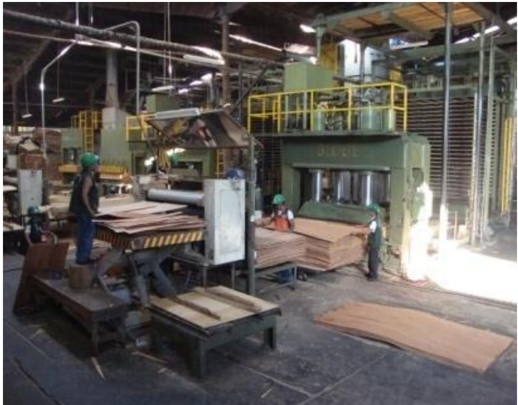
Figura N°21: Encoladora de rodillos para láminas.
