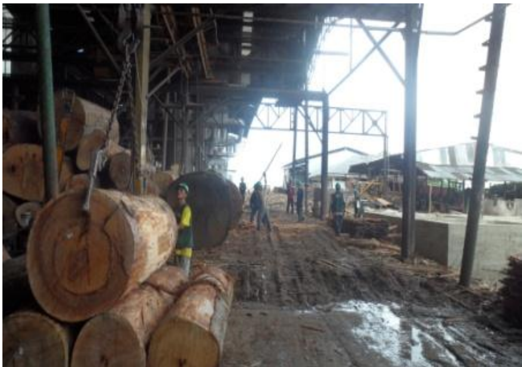
Figura N°06 : Traslado de las trozas al torno mediante el puente grúa.
