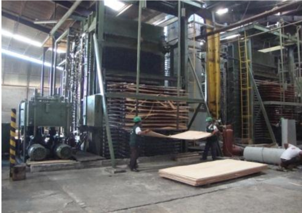
Figura N°25: Salida de las planchas armadas de la prensa caliente.
