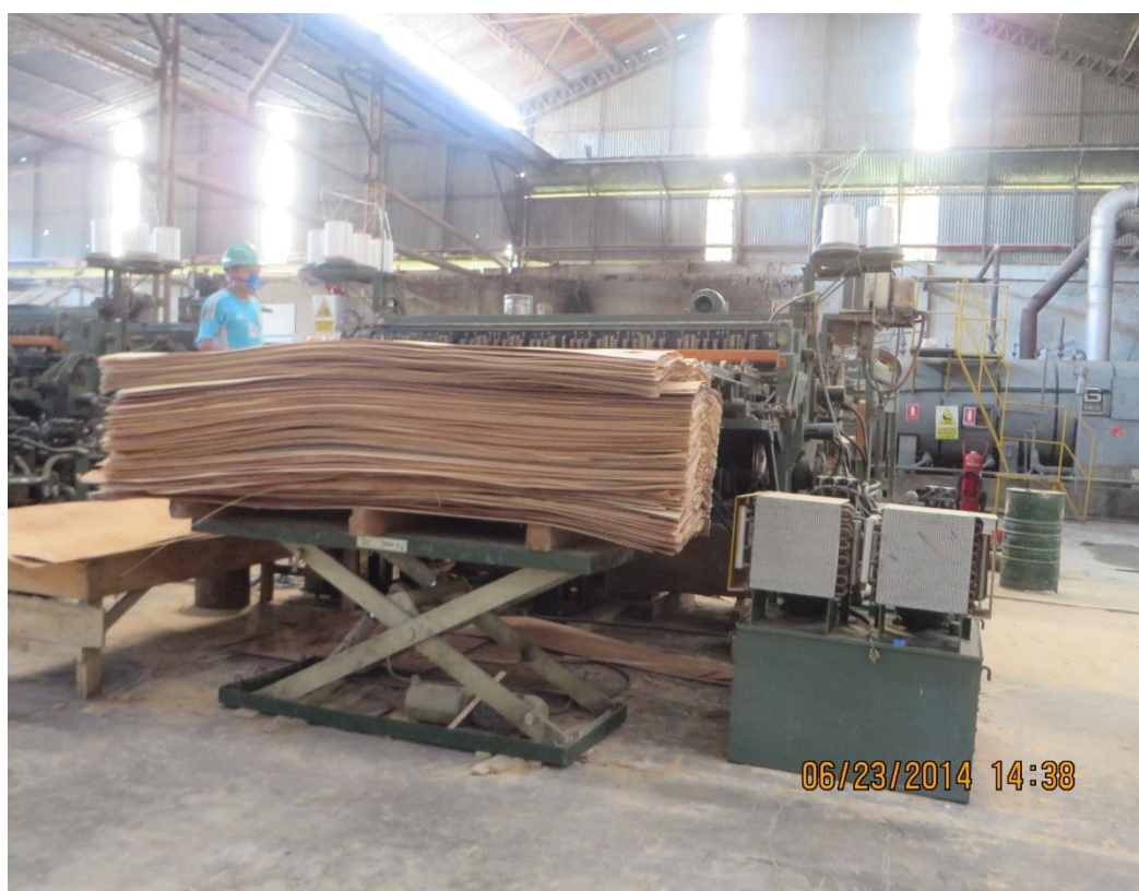
Figura N°17: Ensambladoras de láminas secas para espalda.
