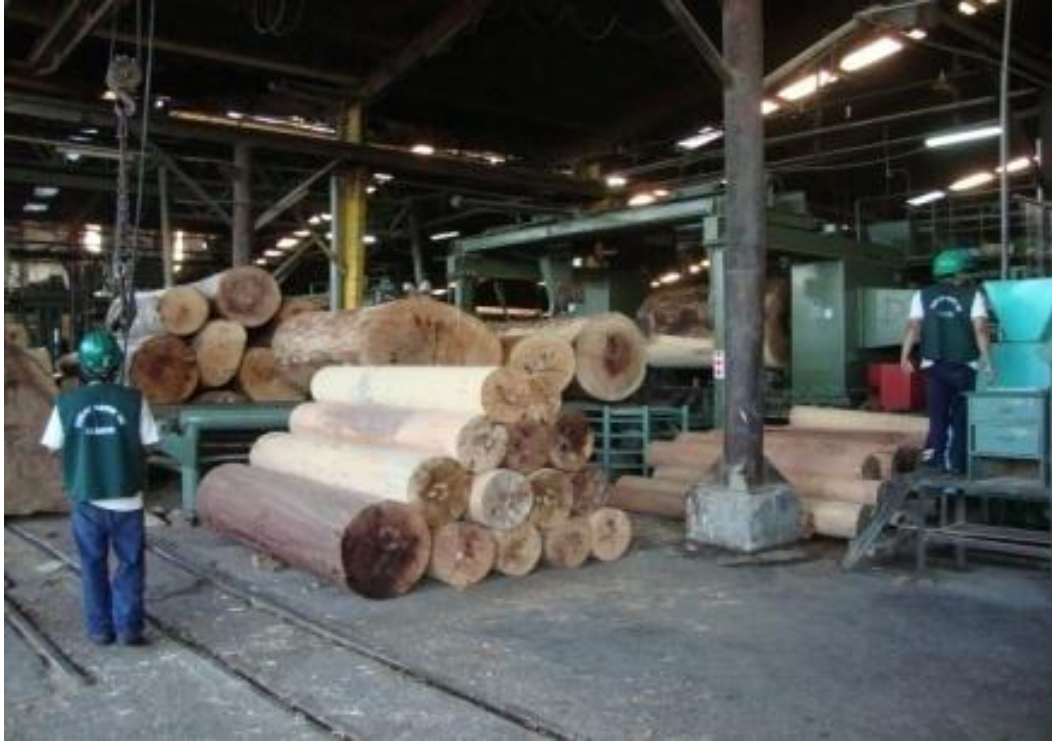
Figura N°09: Polines resultantes del debobinado en los tornos.
