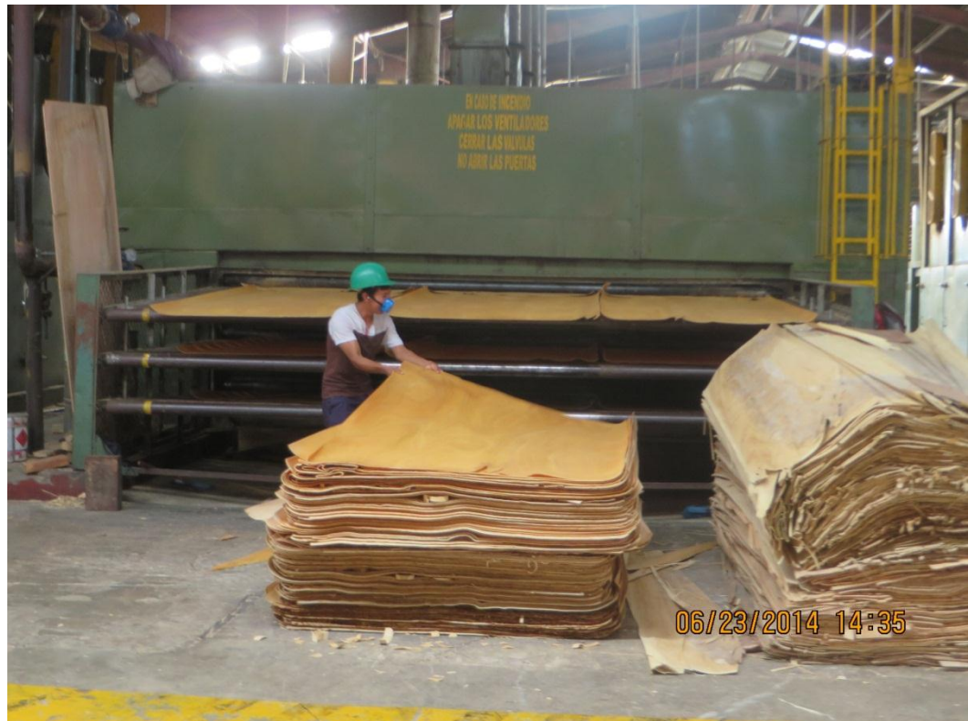
Figura N°11: Ingreso de láminas húmedas en el secadero.
