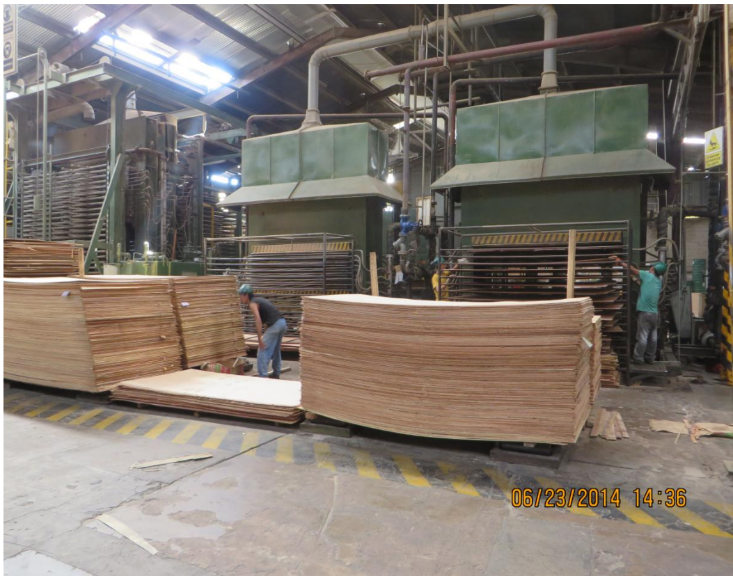
Figura N°26: Paquete armado de material prensado.
