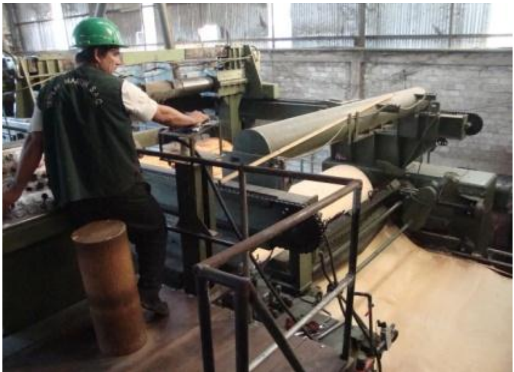
Figura N°07 : Debobinado de las trozas en el torno.
