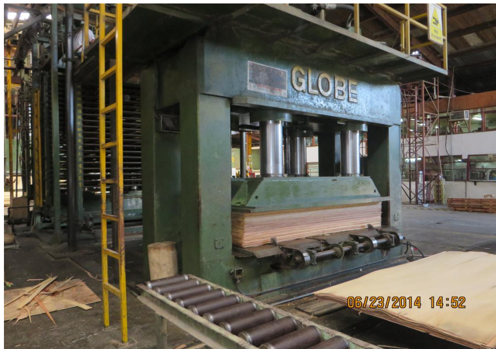
Figura N°23 : Presión de las planchas armadas en la prensa fria.
