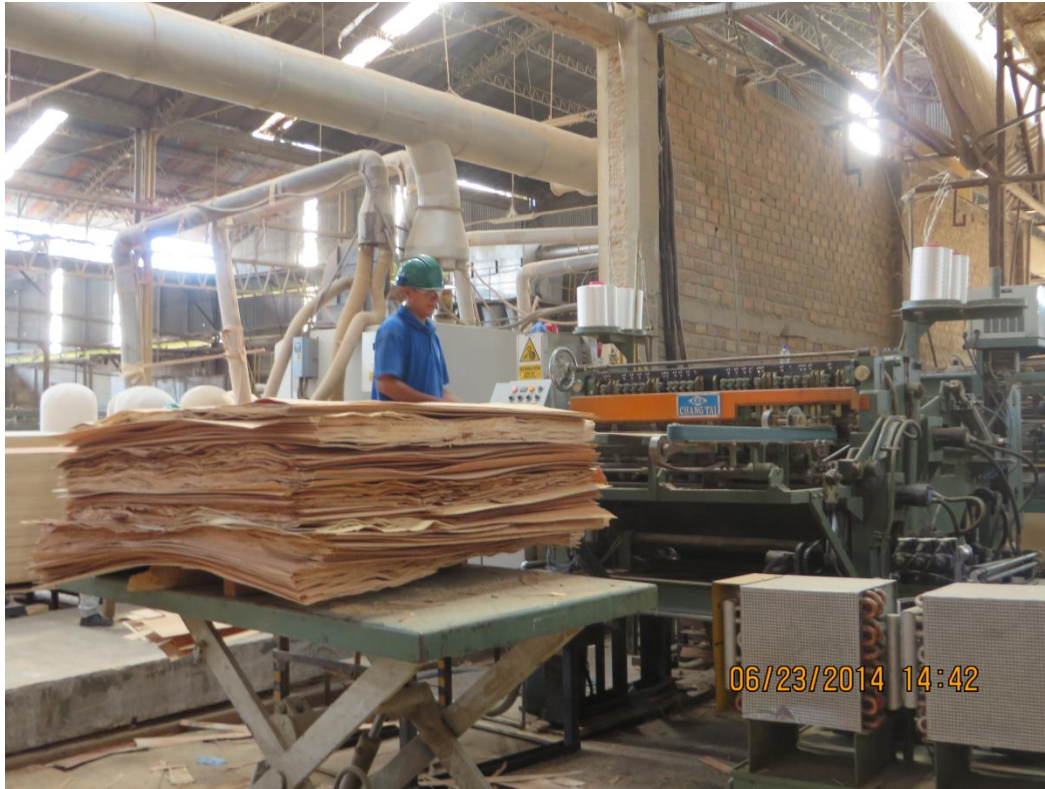
Figura N°18: Ensambladoras de láminas secas para centro.
