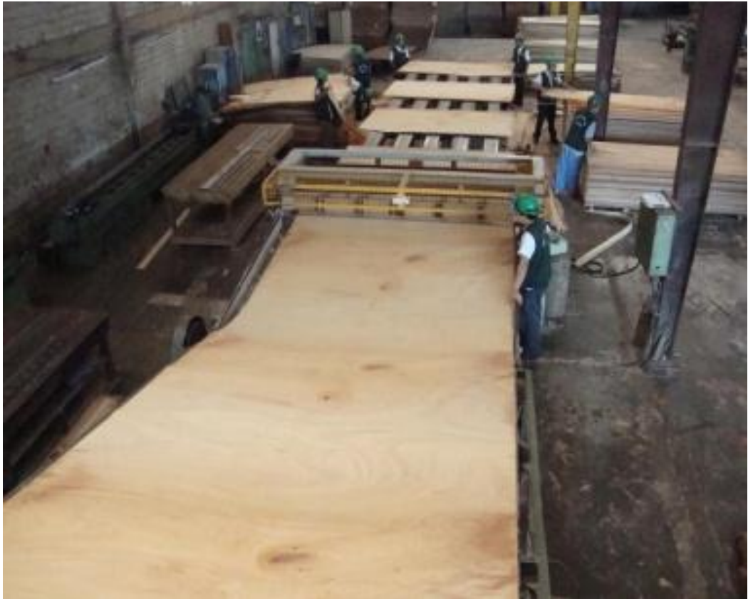
Figura N°08 : Corte del material debobinado en las Cizallas.
