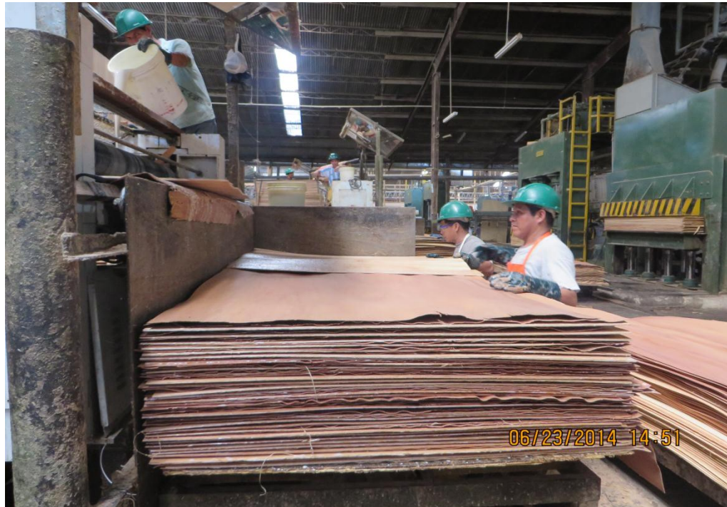
Figura N°22 : Armado de las planchas de triplay.
