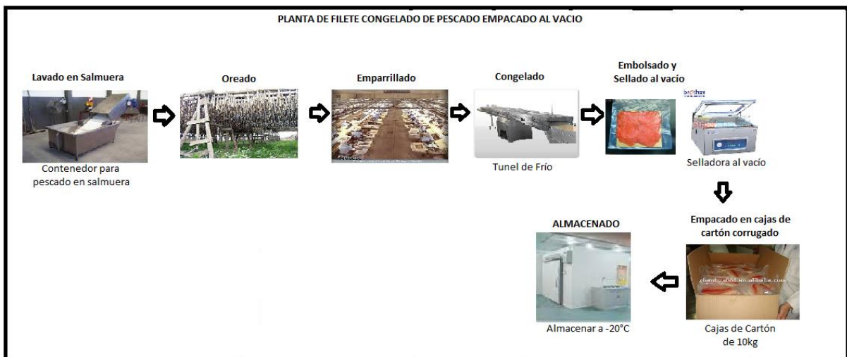
Figura N° 14: Planta de procesamiento de filetes de pescado congelado empacado al vacío. Fuente: Elaboración propia del autor
