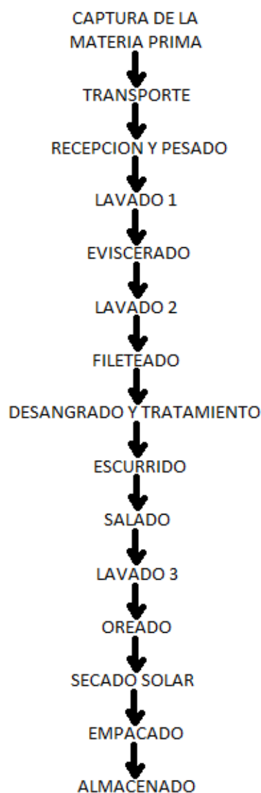
Figura N° 20: Diagrama de flujo de proceso de elaboración de filete de paiche y/o gamitana seco salado.
