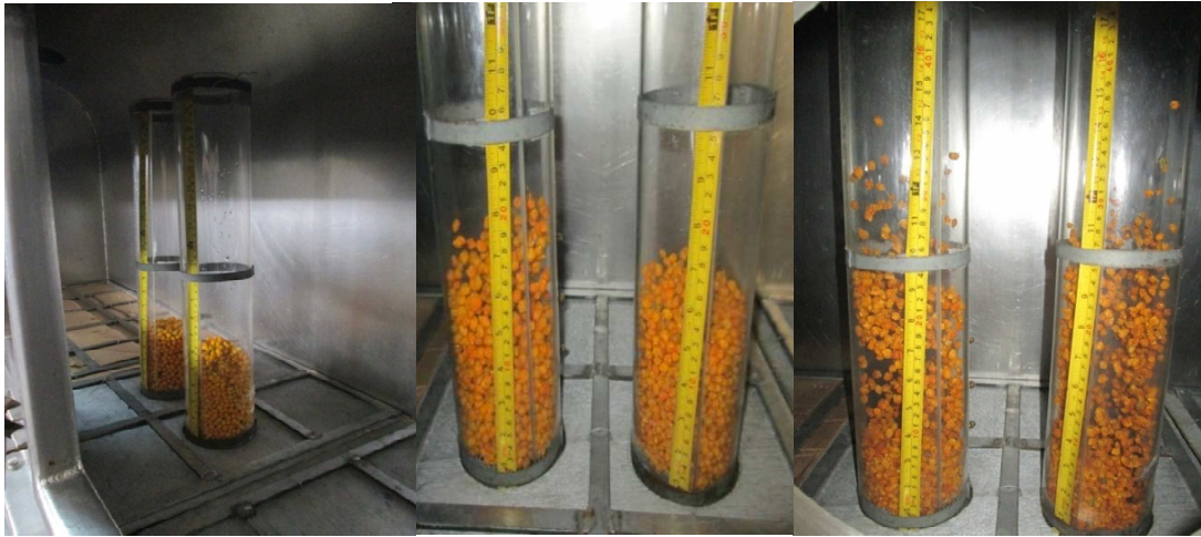
Imagen N° 07. Fluidización de las muestras de ají charapita en secador de lecho fluidizado.
