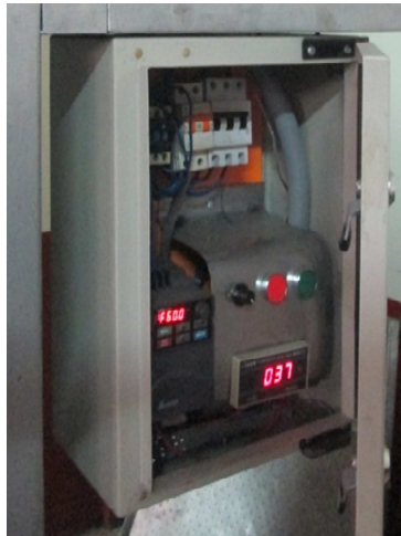
Imagen N° 10. Variador de velocidad de aire en secador de bandejas.
