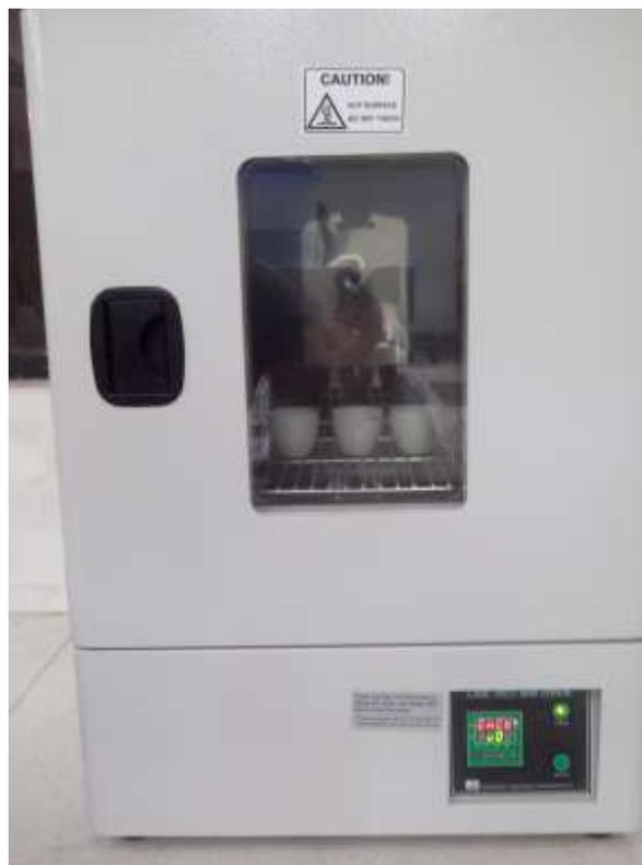
**FOTO N°03. DETERMINACION DE CENIZAS DE LA MUESTRA**
