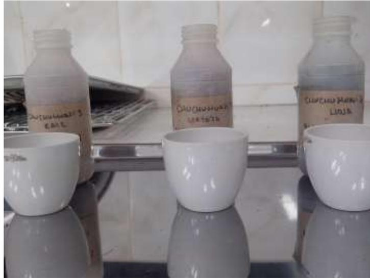
**FOTO N°02. DETERMINANDO LA HUMEDAD DE LA MUESTRA**
